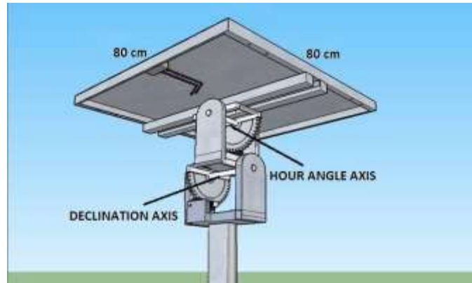
Εικόνα 3.3: Φωτοβολταϊκό διπλού άξονα. Πηγή: International Journal of Renewable Energy Research
