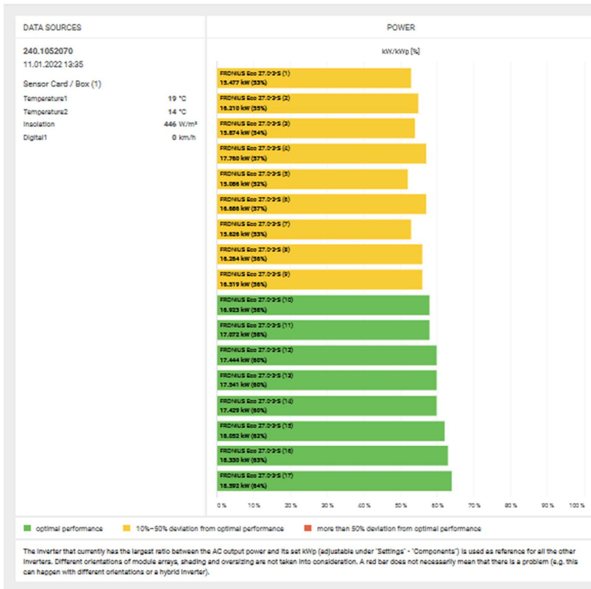
Εικόνα 4.6: Πάρκο με πολλαπλούς μετατροπείς, τμήμα των οποίων σκιάζεται στιγμιαία. Πηγή: https://www.solarweb.com
