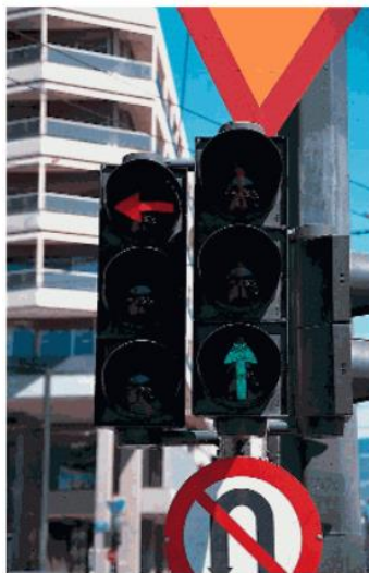
Εικόνα 1.6: Τυπική μορφή φωτεινού σηματοδότη (βέλη πορείας).
