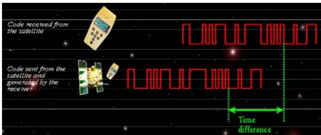
Εικόνα 2.4: Προσδιορισμός χρόνου ταξιδιού σήματος με την χρήση συγχρονισμένου κώδικα
