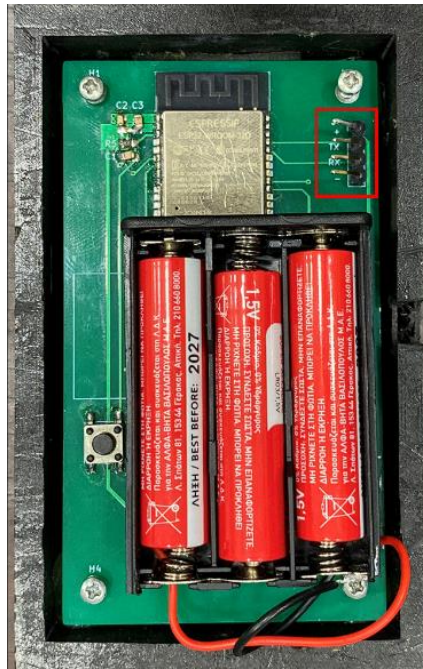
Εικόνα 7.3 : Ακίδες προγραμματισμού πλακέτας
