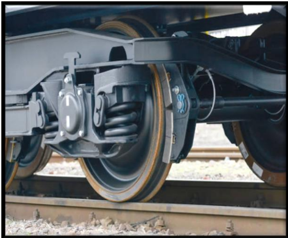
Εικόνα 8. Δισκόφρενα Αμαξοστοιχίας από Χυτοσίδηρο. Πηγή: https://www.istockphoto.com/search/2/image-film?phrase=train+brakes
