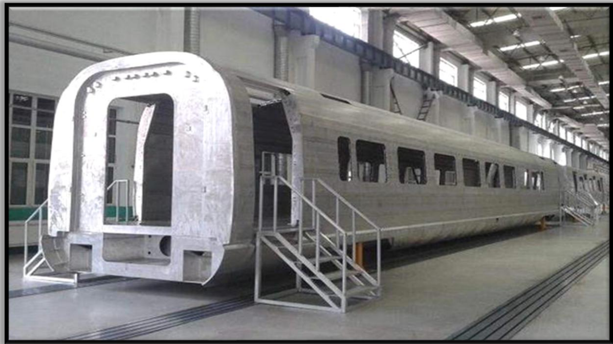
Εικόνα 7. Σκελετός Βαγονιού από Κράματα Αλουμινίου. Πηγή: https://www.intechopen.com/chapters/75650
