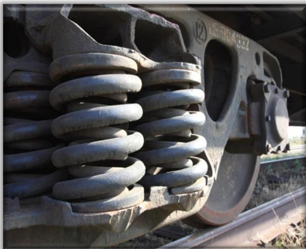
Εικόνα 3. Ελατήρια Χάλυβα σε Αμαξοστοιχία Τραίνου. Πηγή: https://depositphotos.com/gr/photos/rail-freight-wheels.html
