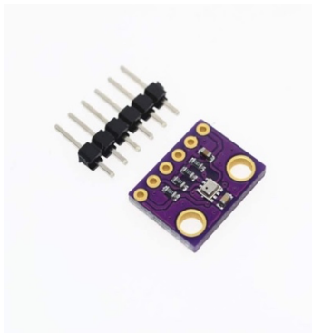
Εικόνα 1.9 αισθητήρας ατμοσφαιρικής πίεσης [39]
