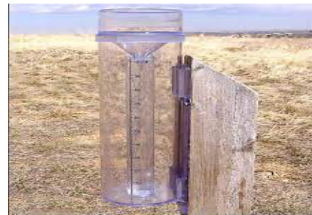
Εικόνα 1.8 αισθητήρας μέτρησης βροχής[38]
