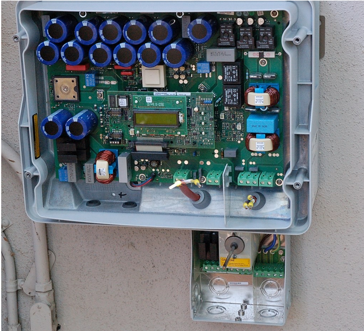
Σχήμα 1.25: Εσωτερικό αντιστροφέα φωτοβολταϊκών. Οι μπλε πυκνωτές αποθηκεύουν ενέργεια και βελτιώνουν τη κυματομορφή εξόδου.
