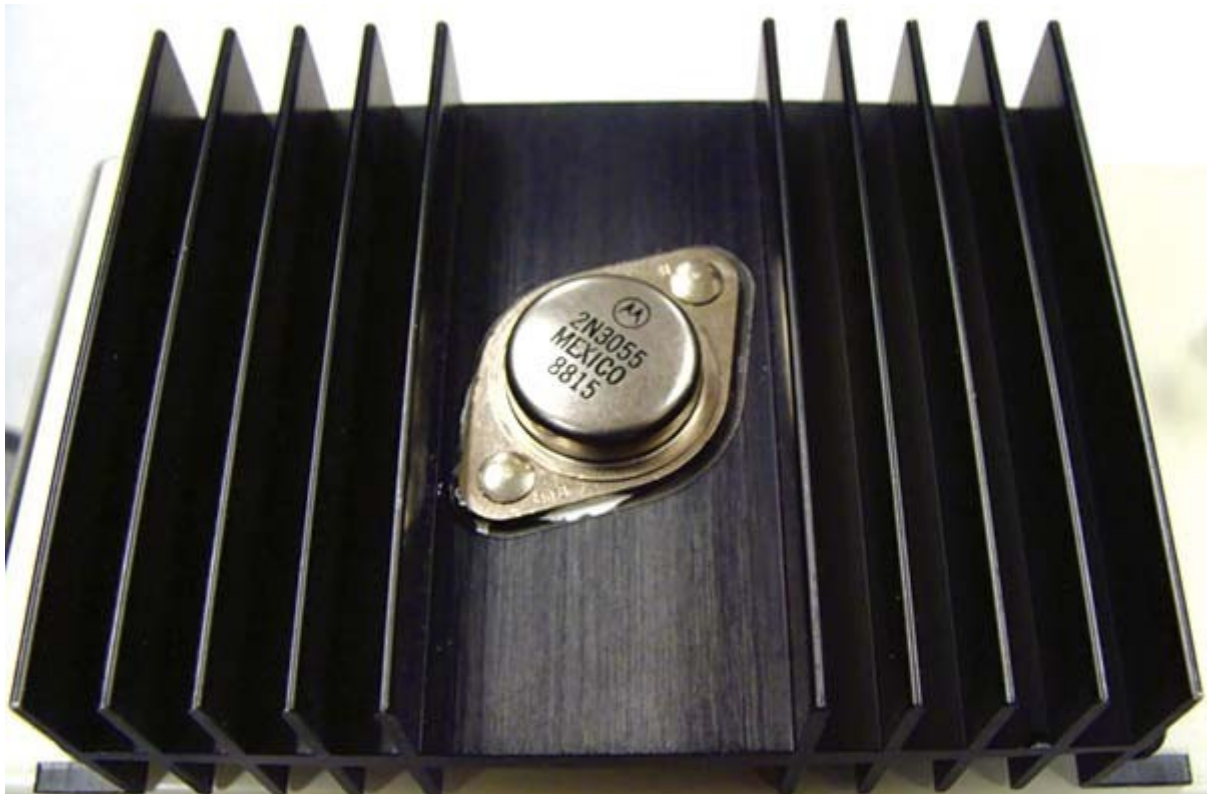
Σχήμα 1.20: Ημιαγωγός διακόπτης ισχύος με περίβλημα τύπου TO-3, τοποθετημένος σε ψύκτρα η οποία ενσωματώνεται στο πίσω μέρος ενός σασί.
