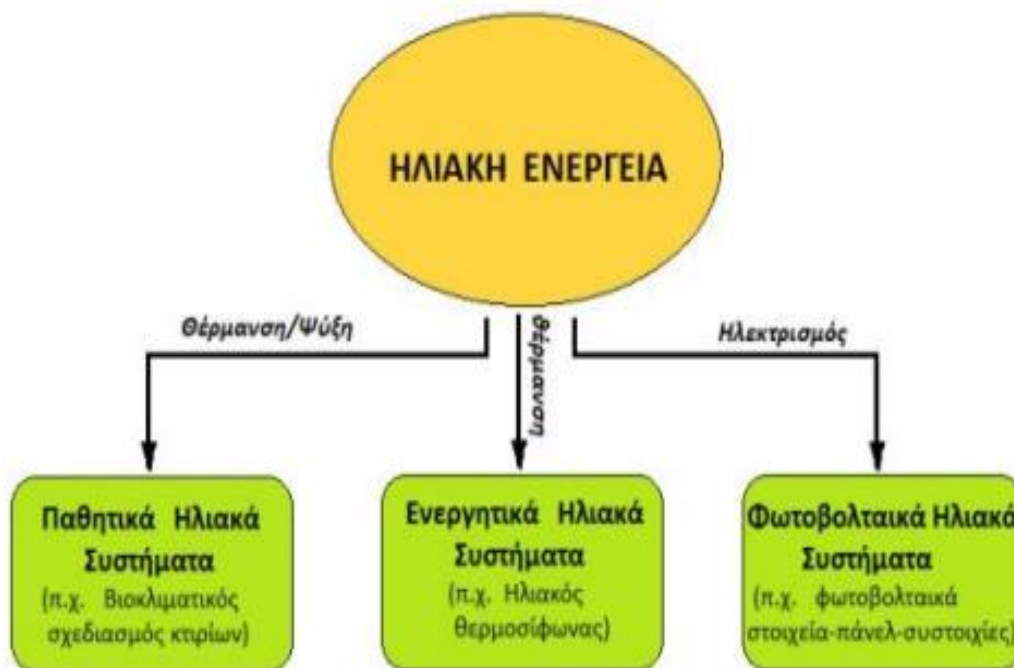
Σχήμα 1.3 Συστήματα εκμετάλλευσης ηλιακής ενέργειας.
