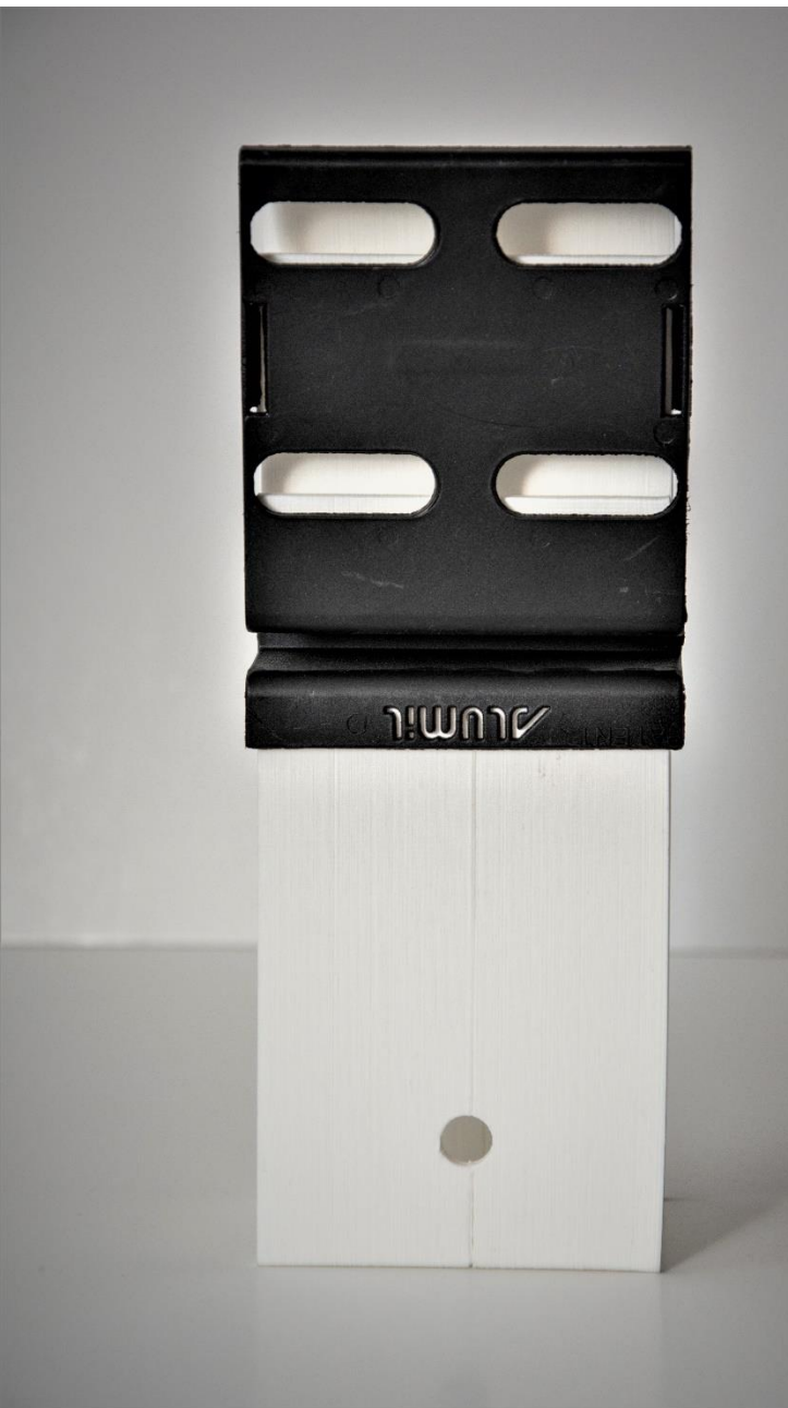
Σχήμα 5.29 Εκτυπωμένος σύνδεσμος μαζί με το μονωτικό υλικό.
