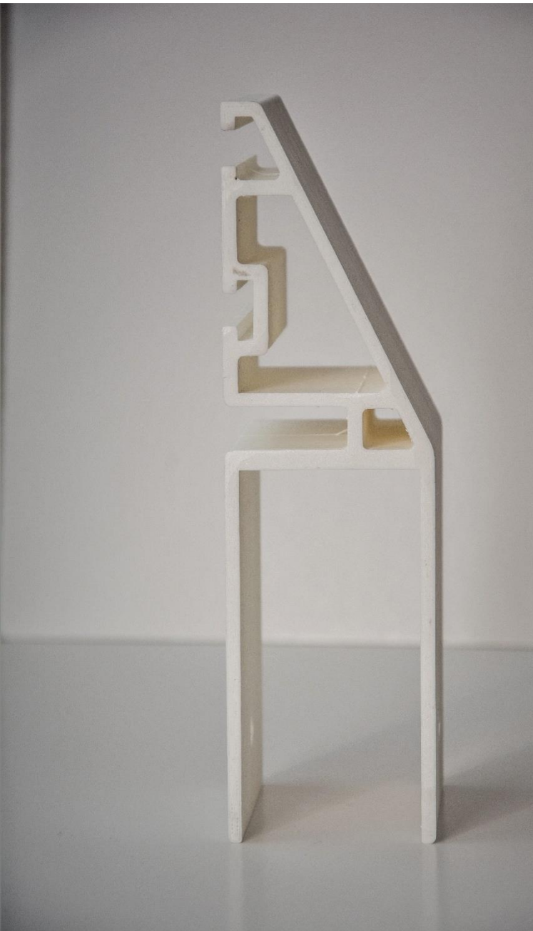
Σχήμα 5.27 Εκτυπωμένος σύνδεσμος με υλικό ABS.
