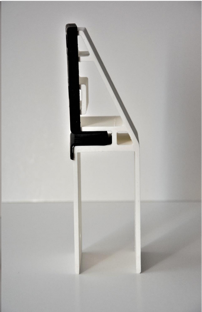
Σχήμα 5.28 Εκτυπωμένος σύνδεσμος μαζί με το μονωτικό υλικό.
