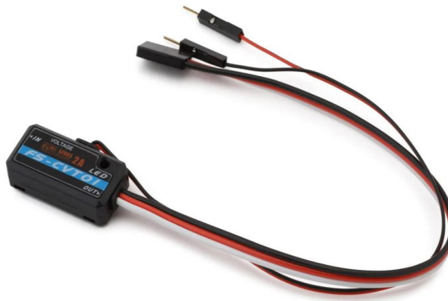
Σχήμα 3.11: Μονάδα Τηλεμετρίας Τάσης FlySky FS-CVT01 [29]
