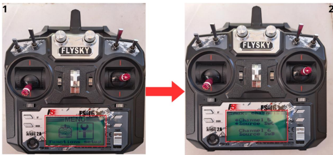
Σχήμα 4.17: Αντιστοίχιση των διακοπτών SwC και SwB στα κανάλια 5 και 6
