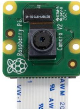
Σχήμα 3.18: Raspberry Pi Camera Module V2 [33]
