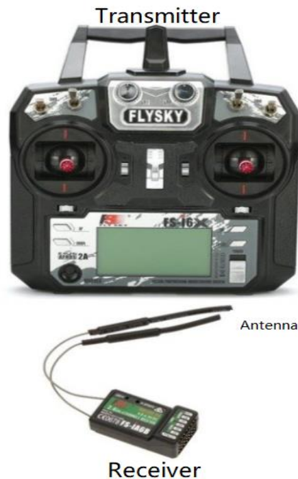
Σχήμα 3.10: Πομποδέκτης Flysky FS-i6x & FS-iA6B [28]
