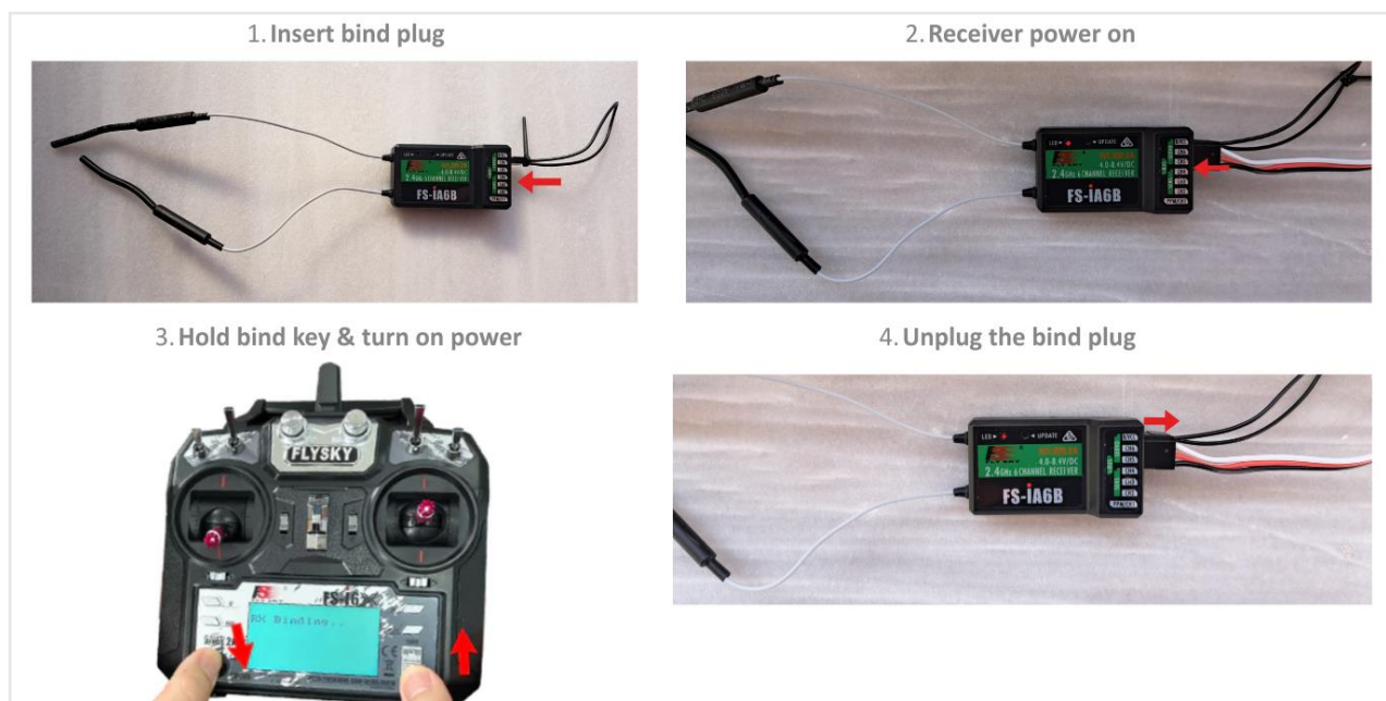
Σχήμα 4.4: Διαδικασία σύζευξης πομπού και δεκτή
