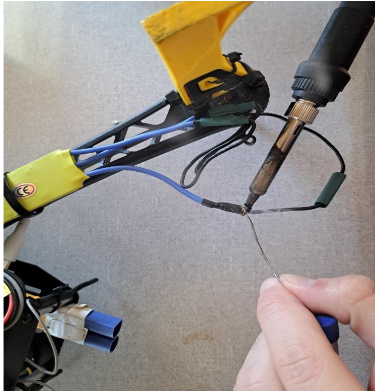
Σχήμα 3.30: Κόλληση των καλωδίων του μοτέρ με το ESC
