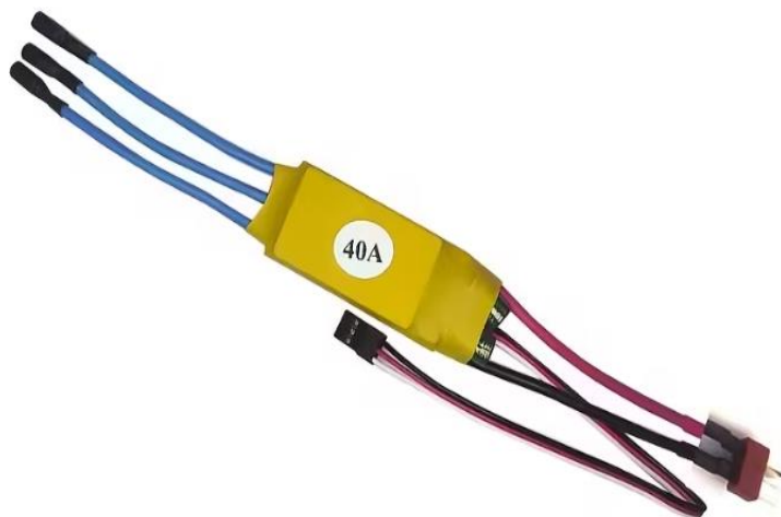
Σχήμα 3.4: Ελεγκτής Ταχύτητας ESC 40A
