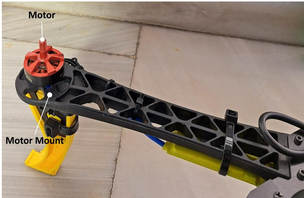
Σχήμα 3.28: Τοποθέτηση κινητήρων στην βάση
