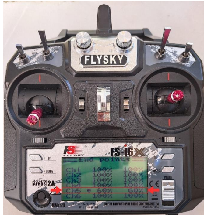
Σχήμα 4.18: Ρύθμιση των End Points του καναλιού 5 στο 60%
