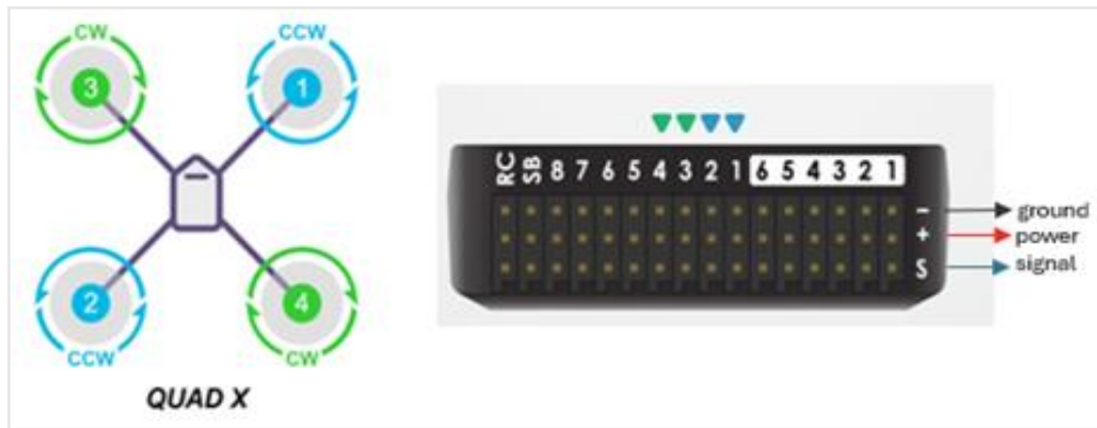
Σχήμα 3.33: Αντιστοίχιση ESC στις εξόδους MAIN OUT του Pixhawk [35]
