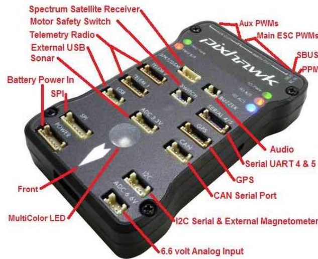
Σχήμα 3.8: Θύρες ελεγκτή πτήσης Pixhawk [26]
