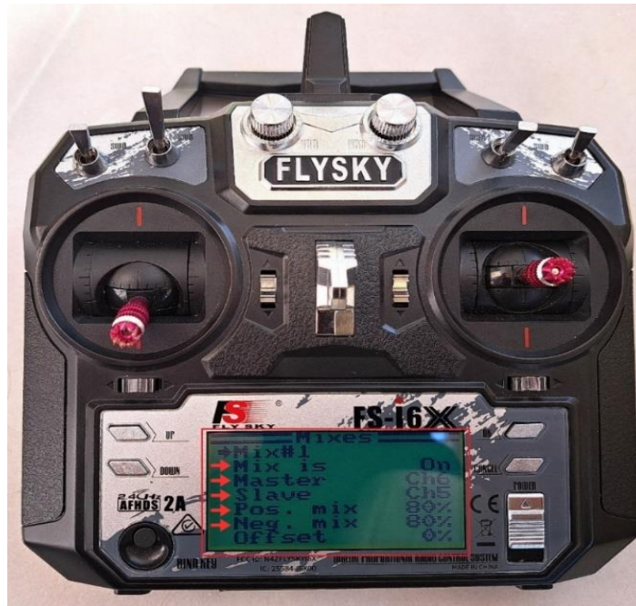
Σχήμα 4.19: Ρύθμιση της μίξης (Mix1)
