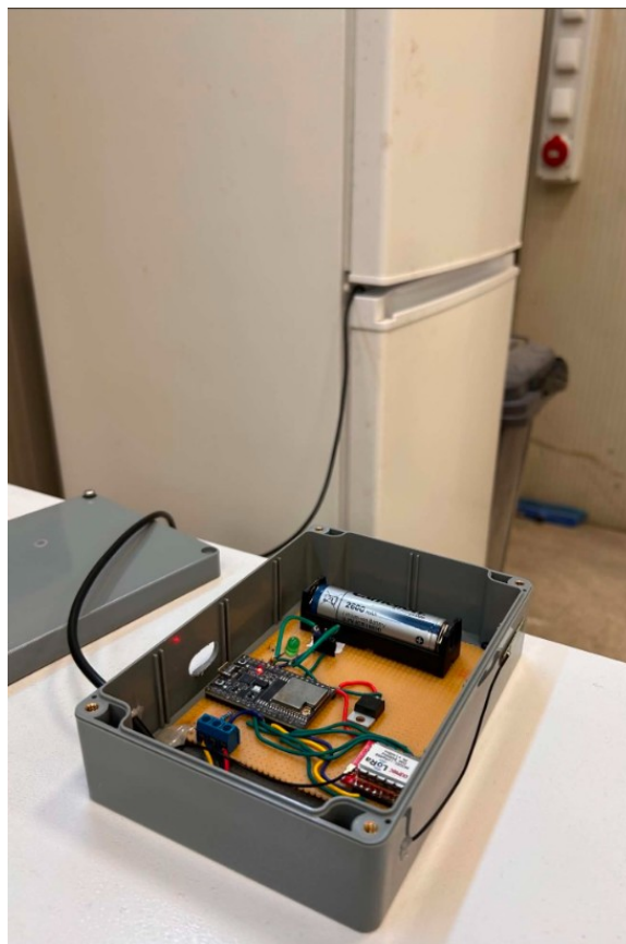
Σχήμα 7.1 – Εγκατάσταση συσκευής αισθητήρα σε ψυκτικό θάλαμο.
