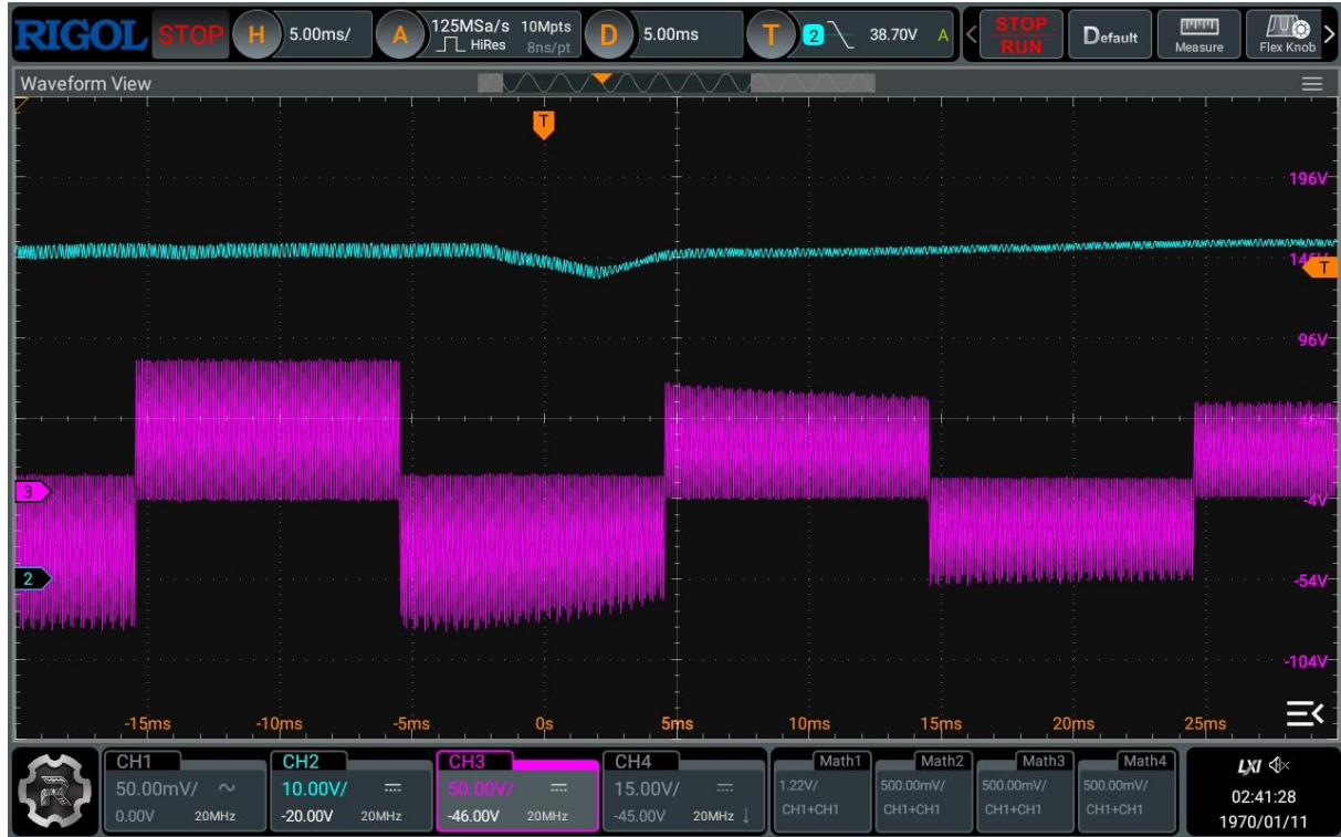
Σχήμα 5.11: Απόκριση της τάσης εισόδου V_{PV} σε απότομη αύξηση του PWM της πλήρους γέφυρας
