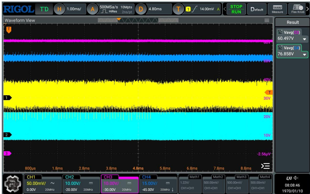
Σχήμα 5.10: Σταθερότητα τάσεων εισόδου και DC link κατά τη λειτουργία της βαθμίδας boost
