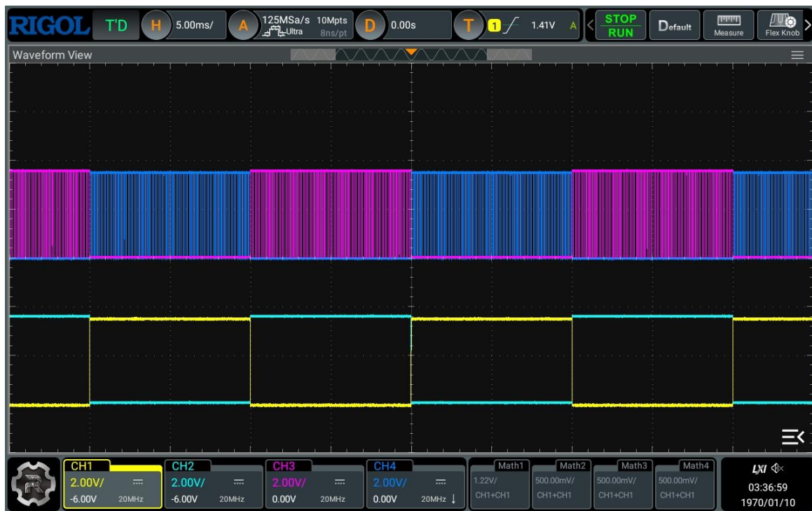
Σχήμα 5.2: Πειραματική επιβεβαίωση χρονισμού οδήγησης της πλήρους γέφυρας
