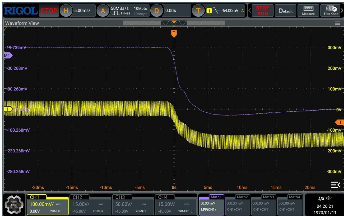
Σχήμα 5.13: Απόκριση του βρόχου ρεύματος σε βηματική μεταβολή της αναφοράς I_{ref}
