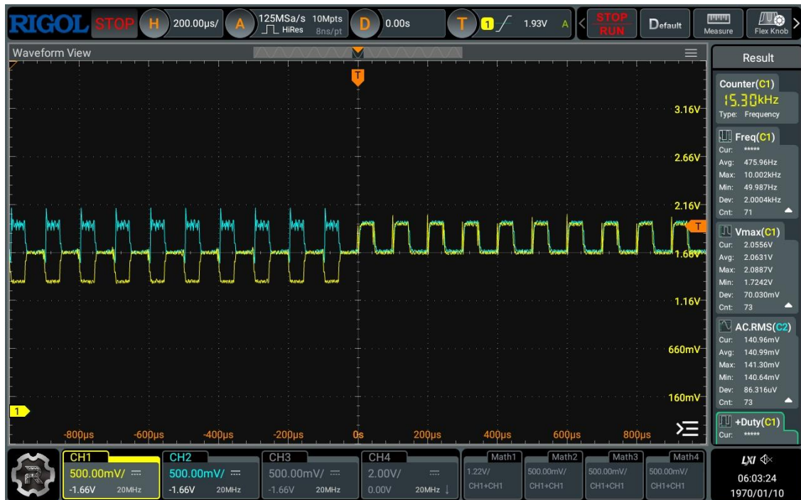
Σχήμα 5.5: Πειραματική επιβεβαίωση λειτουργίας ανορθωτή ακριβείας στη μέτρηση ρεύματος εξόδου
