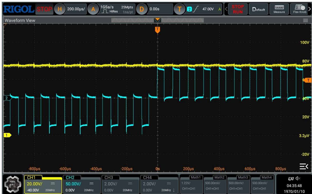
Σχήμα 5.4: Τάση εξόδου της πλήρους γέφυρας και τάση DC link κατά τη λειτουργία του αντιστροφέα
