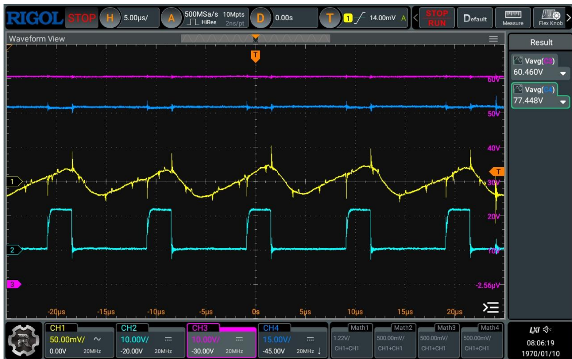
Σχήμα 5.9: Συσχέτιση οδήγησης boost converter, ρεύματος εισόδου και τάσεων V_{PV} , V_{DC \text{ link}}
