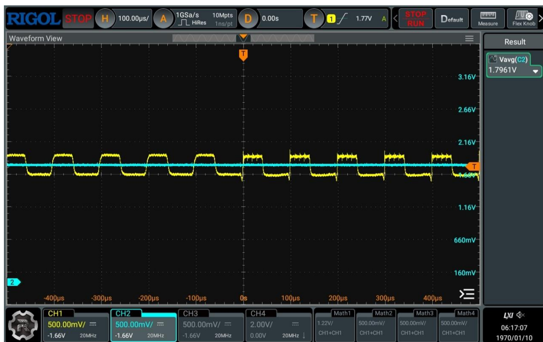
Σχήμα 5.6: Φιλτράρισμα του ανορθωμένου σήματος του ρεύματος εξόδου πριν την είσοδο στο ADC
