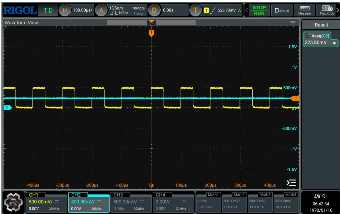
Σχήμα 5.7: Φιλτράρισμα του σήματος μέτρησης τάσης εξόδου της πλήρους γέφυρας πριν την είσοδο στο ADC
