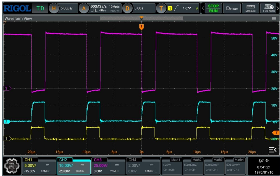
Σχήμα 5.8: Συσχέτιση σήματος οδήγησης, V_{GS} και V_{DS} του MOSFET στη βαθμίδα boost converter
