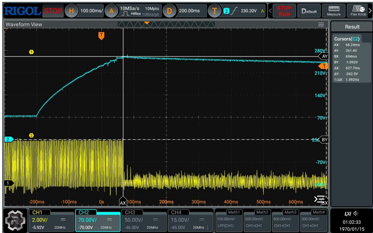
Σχήμα 5.14: Πειραματική επιβεβαίωση προστασίας αποσύνδεσης φορτίου
