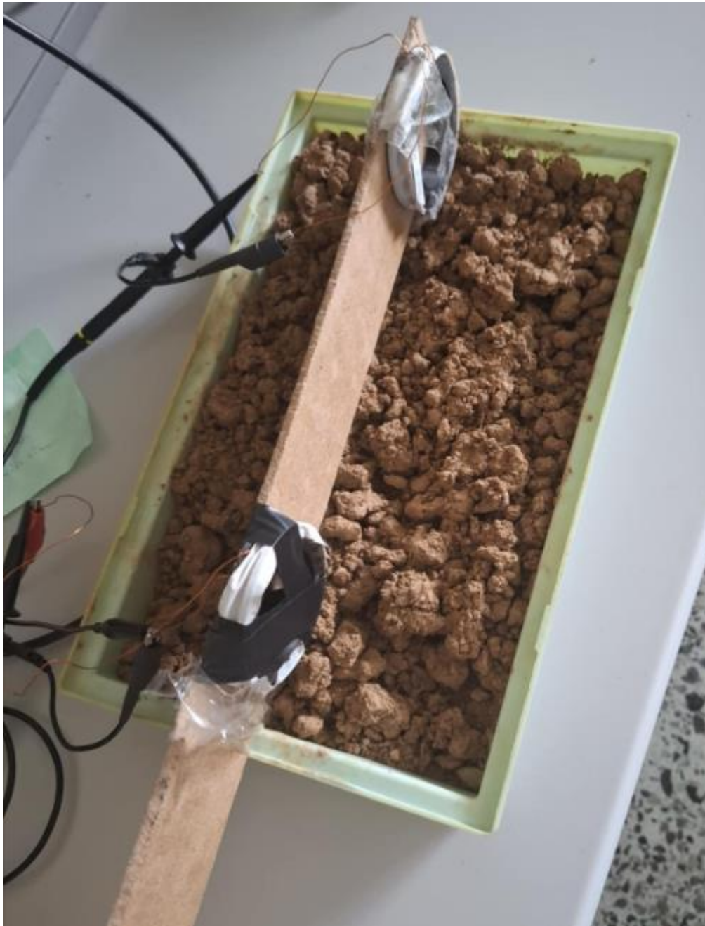
Σχήμα 5.2.3 Μέτρηση χόματος HCP
