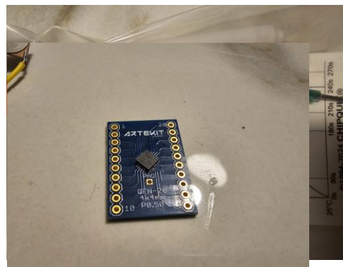
Σχήμα 7.8 - QFN-20 breakout board
