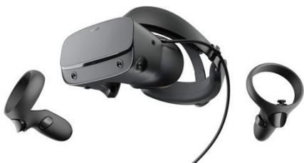
Σχήμα 3.4 – Απτικές Διεπαφές εικονικής και επαυξημένης πραγματικότητας- Δόνησης[26]
