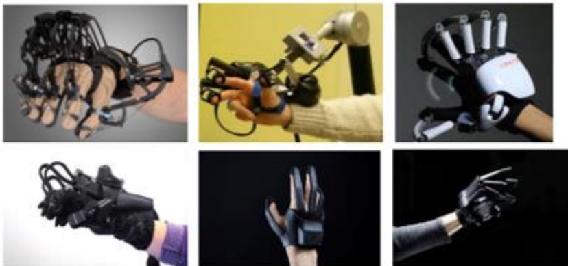
Σχήμα 3.2 – Εξωσκελετικές απτικές Διεπαφές[27]
