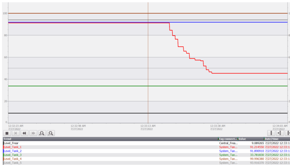
Εικόνα: 69. Οθόνη Screen_Trend- Δεξαμενής Νο2, Νο4 & Νο5 σε Επεξεργασία, Δεξαμενής Νο3 σε Συλλογή, Δεξαμενής Νο1 σε άδειασμα & Κεντρικού Φρεατίου
