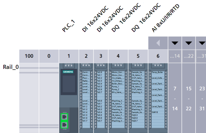
Εικόνα: 6. Η CPU 1513-1 με τις κάρτες Εισόδων και Εξόδων
