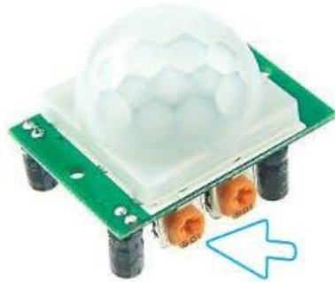
Εικόνα 3.7: Ρύθμιση του PIR [9]
