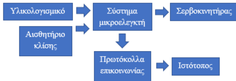
Σχήμα 3-1: Μπλοκ διάγραμμα ενσωματωμένου συστήματος απομακρυσμένου ελέγχου.
