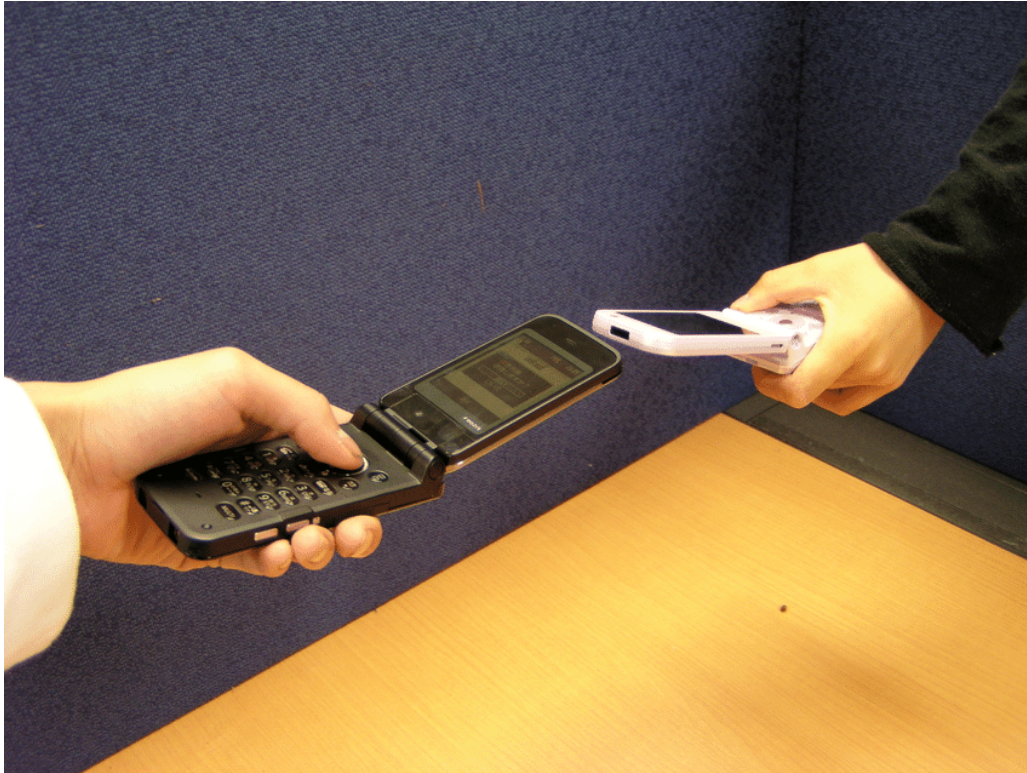
Σχήμα 2.5: Επικοινωνία μεταξύ 2 κινητών συσκευών με χρήση υπέρυθρων [104].
