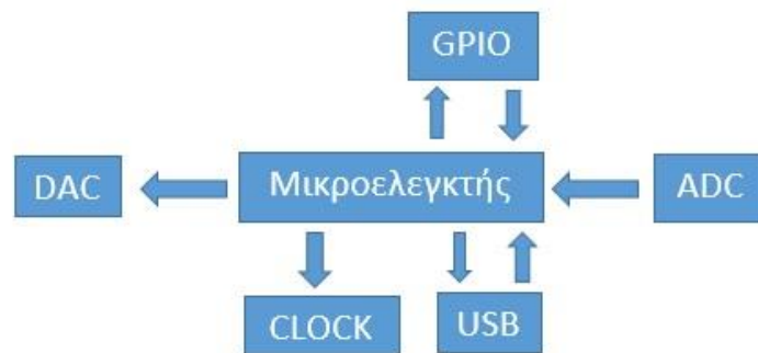
Σχήμα 3-5: Μπλοκ διάγραμμα συστήματος μικροελεγκτή χρονιστή
