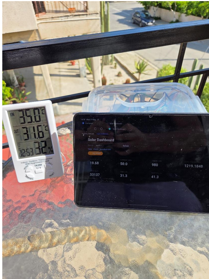
Εικόνα 9: Συγκριτικός έλεγχος θερμοκρασίας μεταξύ του αισθητήρα DHT22, όπως εμφανίζεται στο web dashboard και ανεξάρτητου ψηφιακού θερμομέτρου αναφοράς σε εξωτερικές συνθήκες.
