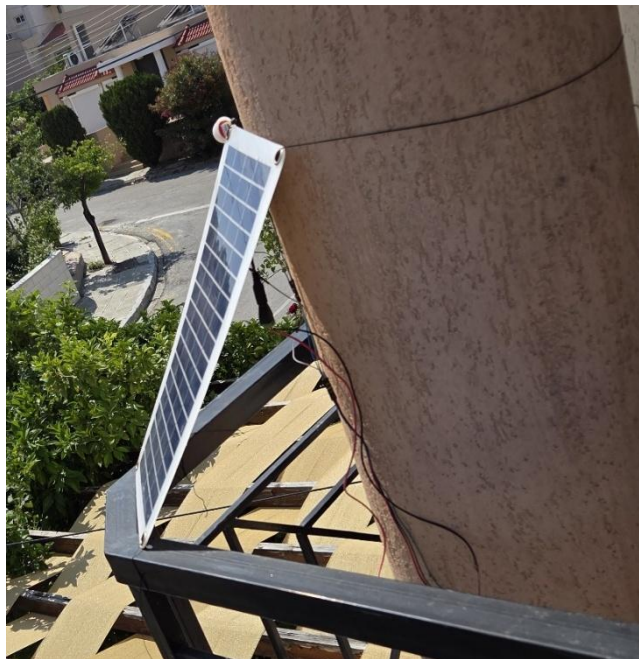
Εικόνα 24: Τοποθέτηση του φωτοβολταϊκού πάνελ σε εξωτερικό χώρο, με σταθερή κλίση και έκθεση στην ηλιακή ακτινοβολία κατά τη διάρκεια των πειραματικών μετρήσεων.
