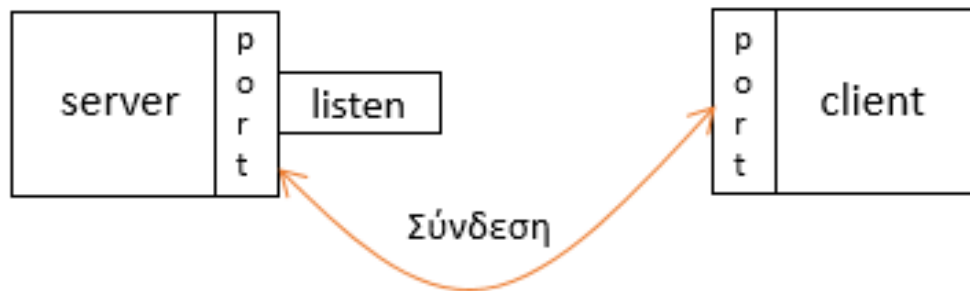
Σχήμα 2.11: Σύνδεση με tcp socket client-server
