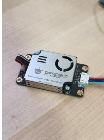
Εικόνα 5.6: Οπτικός αισθητήρας αιωρούμενων σωματιδίων PM2.5 της DFRobot. Η επικοινωνία με τον μικροελεγκτή πραγματοποιείται μέσω διαύλου I2C, ενώ η τροφοδοσία παρέχεται από γραμμή 5V.
