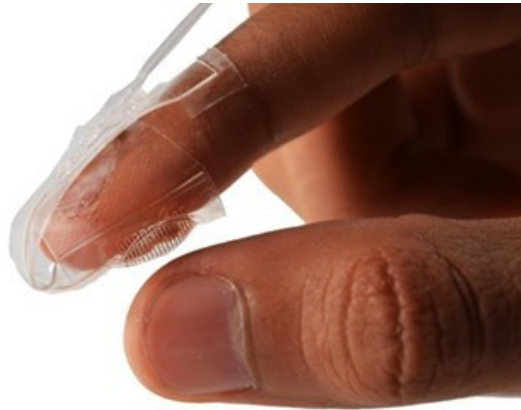
Εικόνα 6 Απτικά τοποθετημένα ανάμεσα σε στρώματα σιλικόνης (EPFL, 2019)
