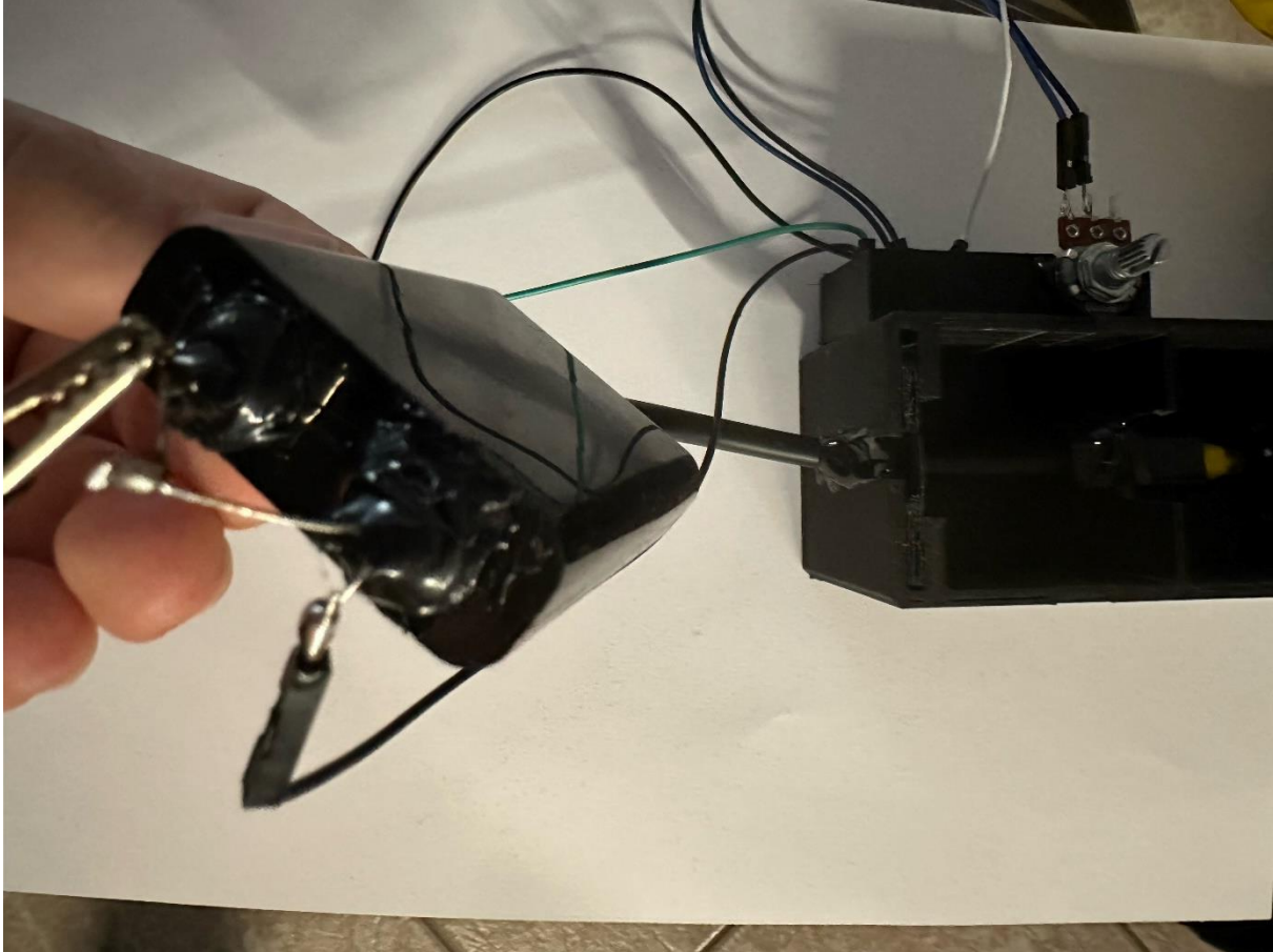
Εικόνα 51. Toslink με τις κολλήσεις και τις μονώσεις του.
