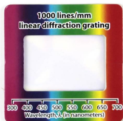
Εικόνα 29 Diffraction grating 1000lines (Φράγμα περίθλασης).
