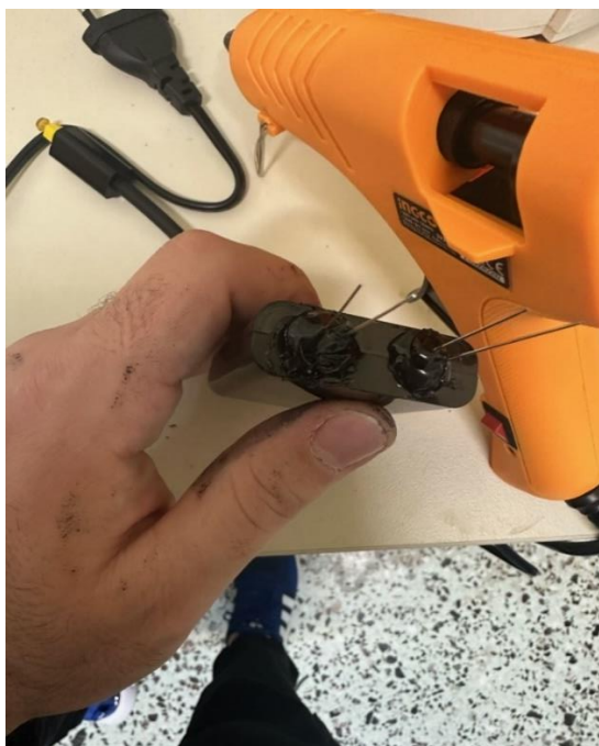
Εικόνα 32. Κόλληση με σιλικόνη τα LED στο Toslink.
