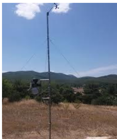
Εικόνα 1: Αυτόματος μετεωρολογικός σταθμός εθνικού αστεροσκοπείου στην Μάνδρα Αττικής (πηγή www.meteo.gr ).
