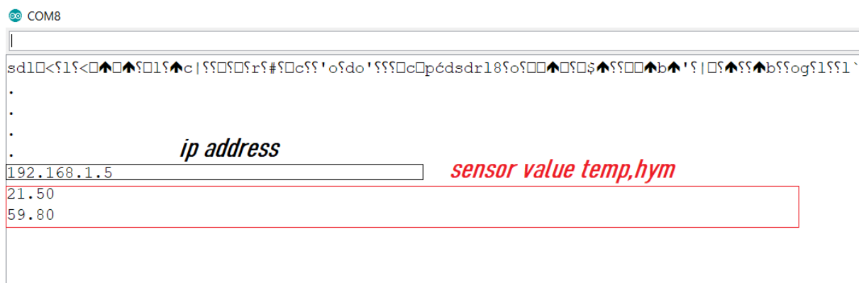
Εικόνα 2.7.2 στοιχεία στην σειριακή θύρα του ESP8266
