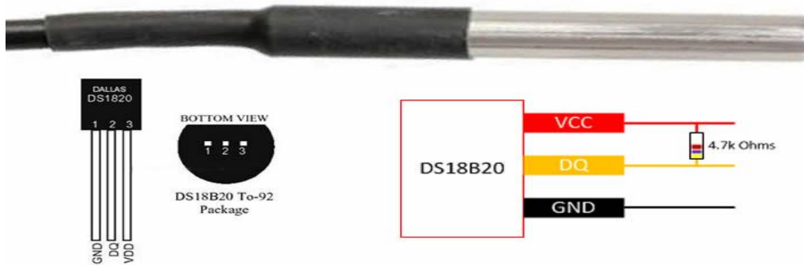
Εικόνα 2.3.1 ηλεκτρονικό θερμομέτρο και μέρος των συνδέσεων.
