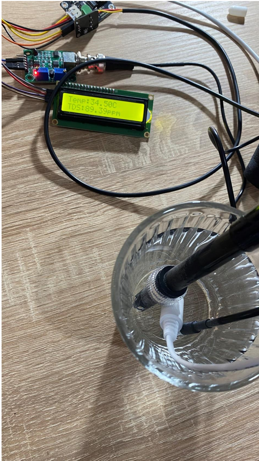
Εικόνα 23. Εμφάνιση θερμοκρασίας >25^{\circ}\text{C} οπότε ο κώδικας θα μας εμφανίσει ότι το νερό δεν είναι πόσιμο.
