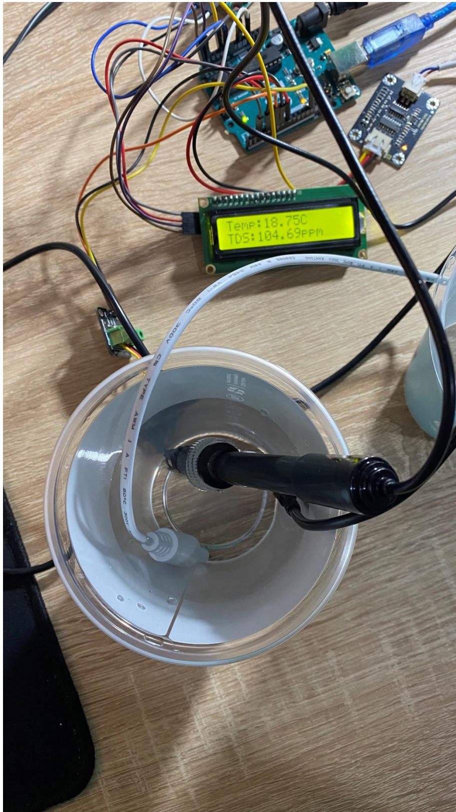
Εικόνα 27. Μέτρηση νερού βρύσης αφού περάσει από φίλτρο.
