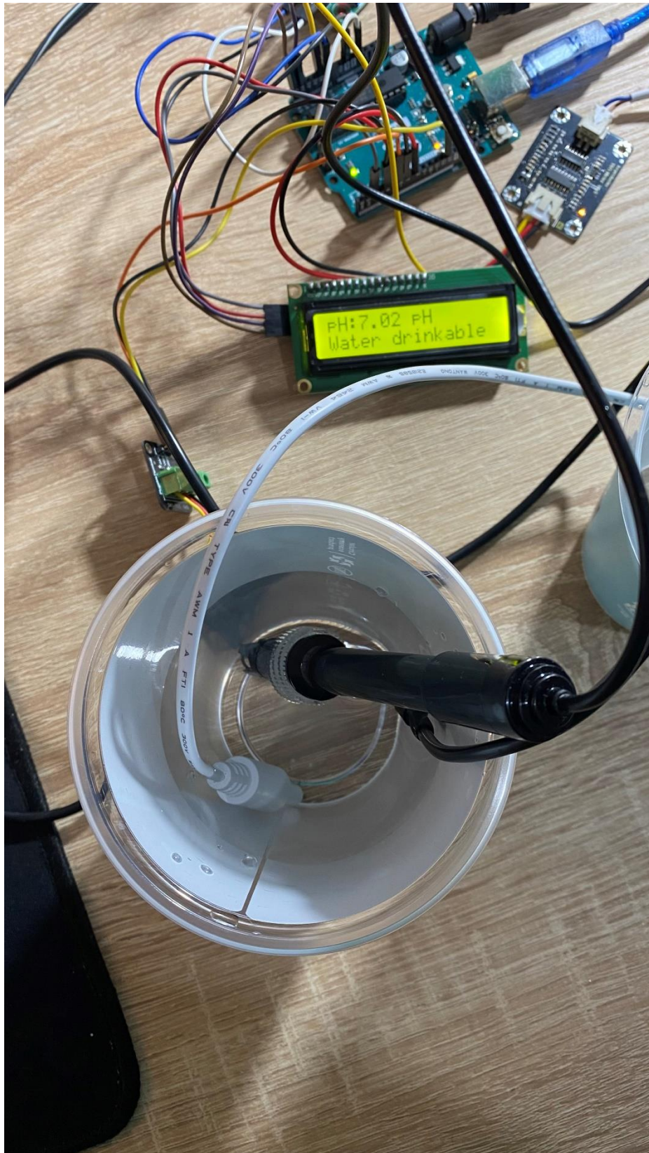
Εικόνα 28. Εμφάνιση ότι το νερό είναι πόσιμο αφού όλες οι μετρήσεις μας είναι εντός επιτρεπτών ορίων.
