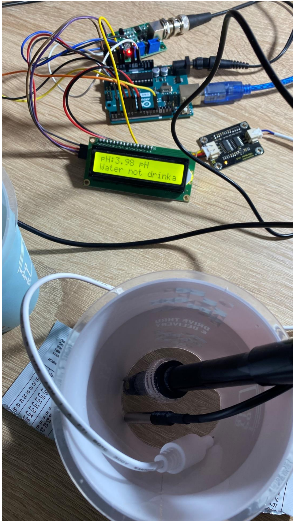
Εικόνα 30. Σωστά μας εμφανίζει το αποτέλεσμα ότι το νερό δεν είναι πόσιμο καθώς η οξύτητα του νερού είναι εκτός ορίων.
