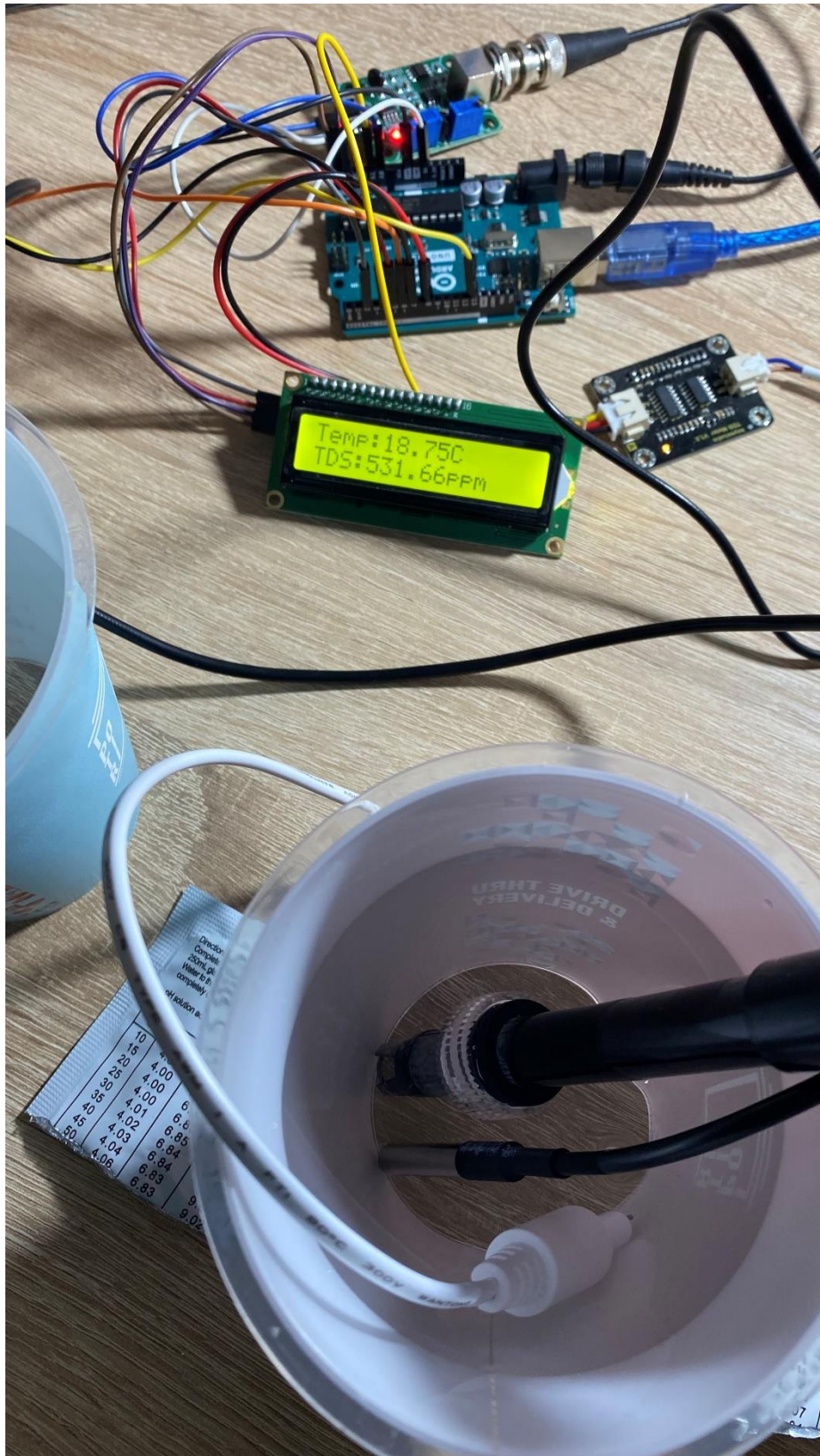
Εικόνα 29. Μέτρηση ποιότητας νερού διαλύματος γνωστού 4pH στους 25C.
