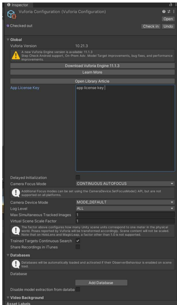
Σχήμα 4.21: Το παράθυρο Vuforia Configuration μέσα στον Unity Editor, όπου εισάγεται το App License Key
