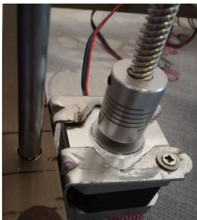
Εικ.3 Σύνδεση κινητήρα Z με σπυρωτό άξονα
