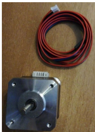
Εικ.4.9 Βηματικός Κινητήρας NEMA 17HS19-2004S
