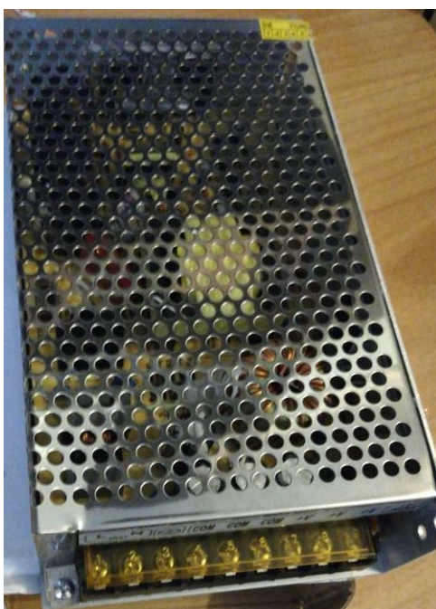
Εικ.4.6 Τροφοδοτικό FLSUN 240W
