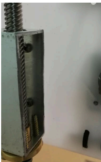
Εικ.4.1 Κατασκευή κίνησης στον άξονα Z
