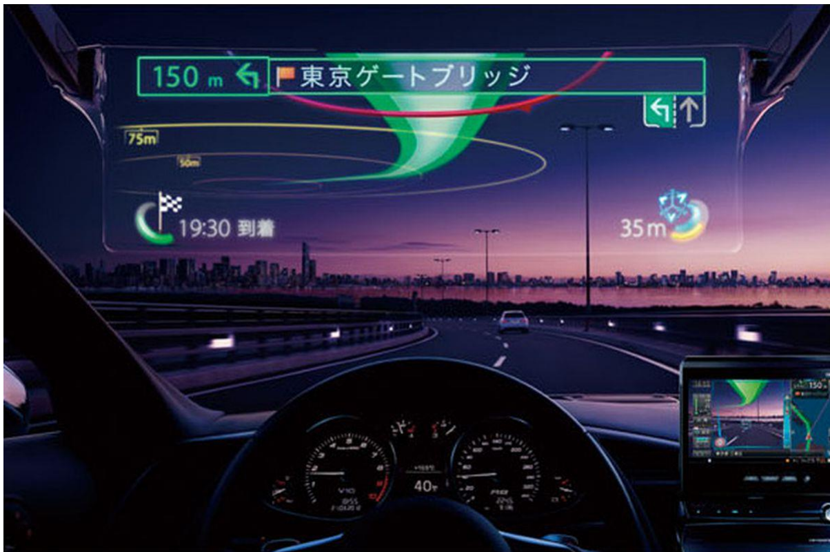
Σχήμα 3.1: Η τεχνολογία προβολής κεφαλής για την περίπτωση της οδήγησης αυτοκινήτου (Car HUD) [17]
