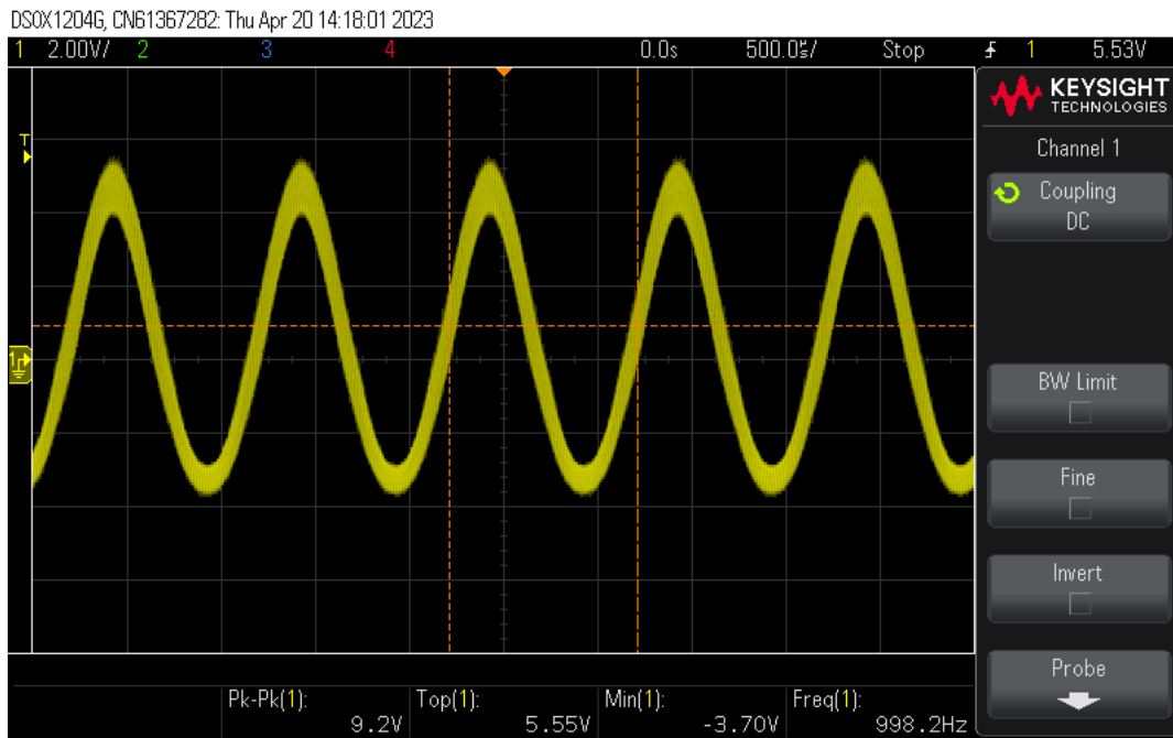
Σχήμα 4.27: Κυματομορφή εξόδου συστήματος αριστερού καναλιού (0 dB)
