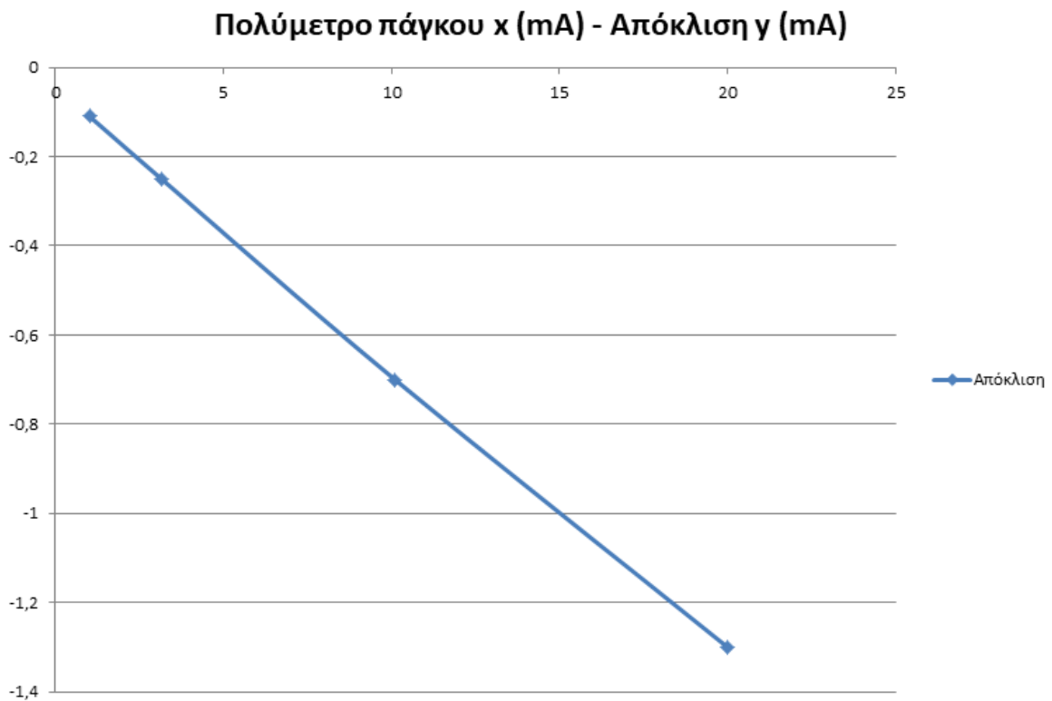
Εικόνα 4.8: Απόκλιση τιμών οργάνου μέτρησης σε σχέση με αυτές του πολυμέτρου πάγκου (1...20mA)
