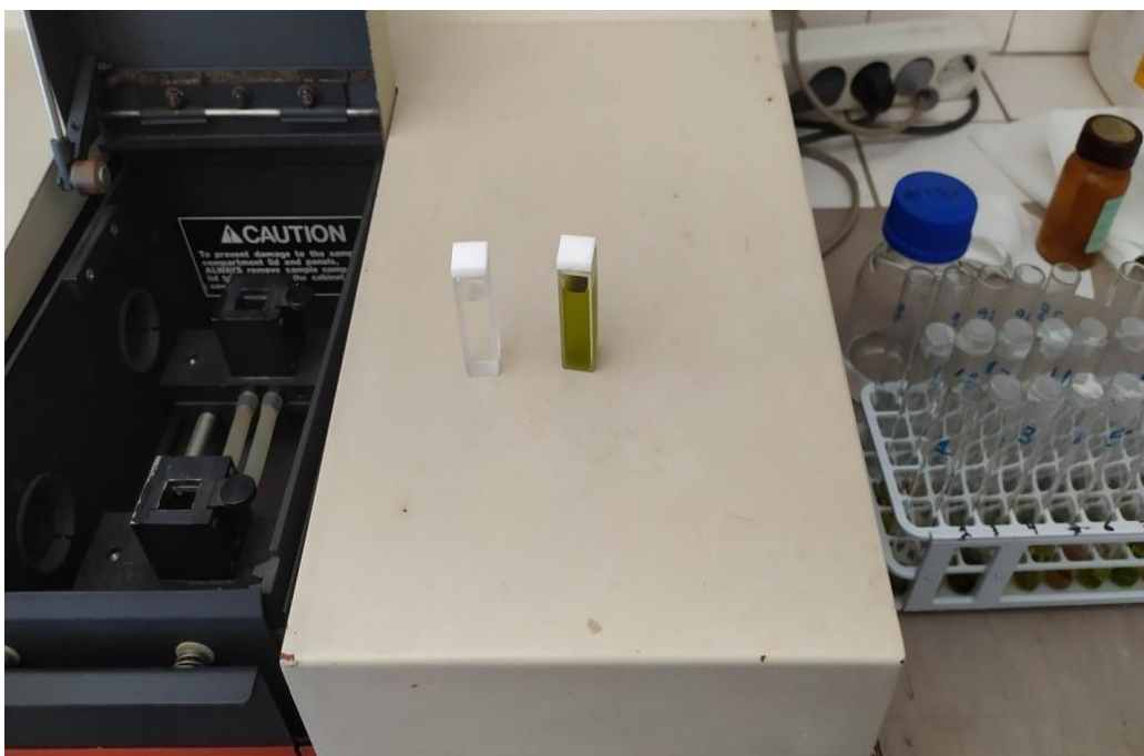
Εικόνα 5.10: Κυψελίδες από χαλαζία για λήψη φασμάτων UV-Vis. Αριστερά στο άνοιγμα του οργάνου φαίνεται ο χώρος τοποθέτησης των κυψελίδων δείγματος και αναφοράς, για μέτρηση με τη διπλή δέσμη της λυχνίας του φασματοφωτομέτρου
