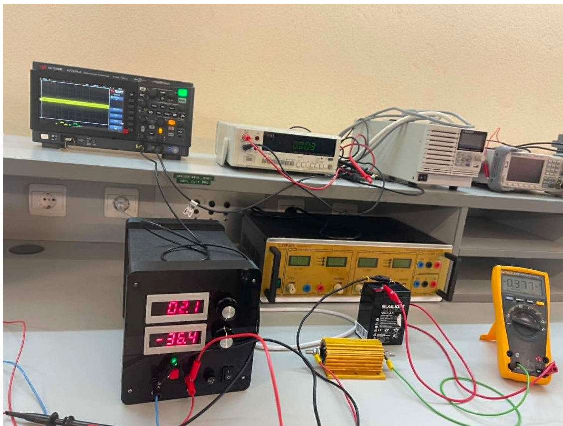
Σχήμα 5.1: Πειραματική συνδεσμολογία παλμογράφου, ωμικού φορτίου και μπαταρίας στην έξοδο του προσομοιωτή.
