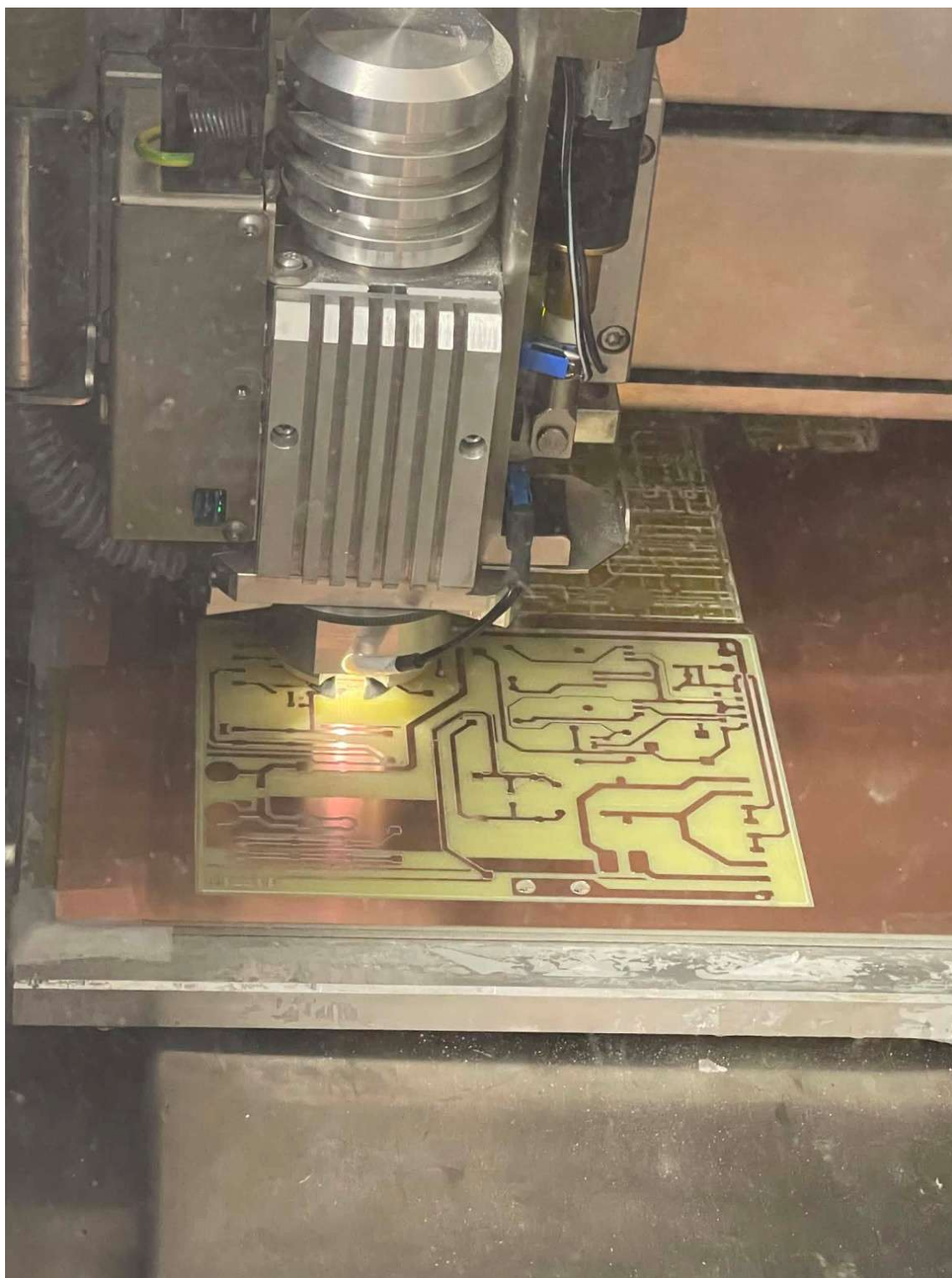
Σχήμα 4.5: Πραγματική διαδικασία isolation milling της πλακέτας στο LPKF.
