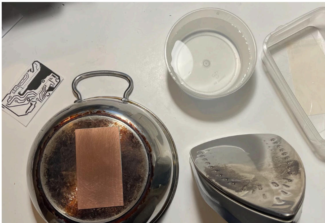
Εικόνα 27. Θερμική Μεταφορά Γραφίτη σε PCB, Πηγή: κάμερα κινητού.
