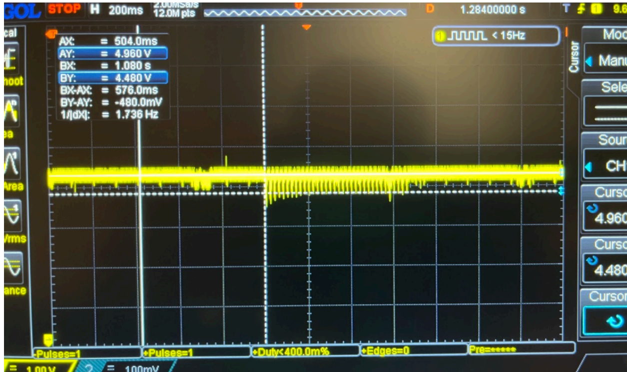
Σχήμα X.3: Τάση VCC και Voltage Drop Σερβοκινητήρα
