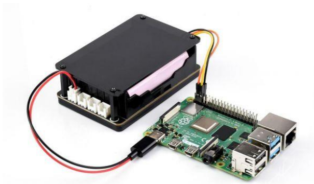
Εικόνα 3.9: UPS Module 3s
