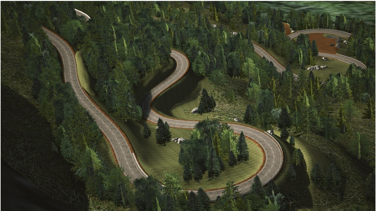
Εικόνα 3.1. Αναδημιουργημένος δρόμος με τεχνολογία σάρωσης λέιζερ.
