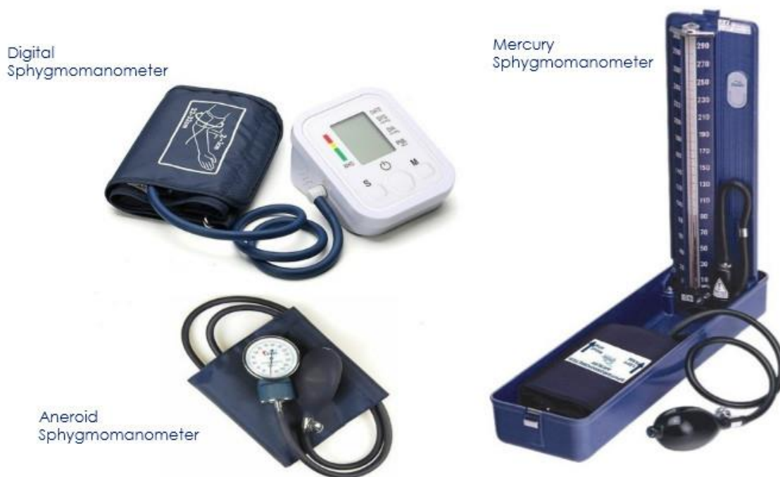
Εικόνα 1.11 Ψηφιακό πιεσόμετρο, πιεσόμετρο υδραργύρου και πιεσόμετρο άνευ υδραργύρου [55]
