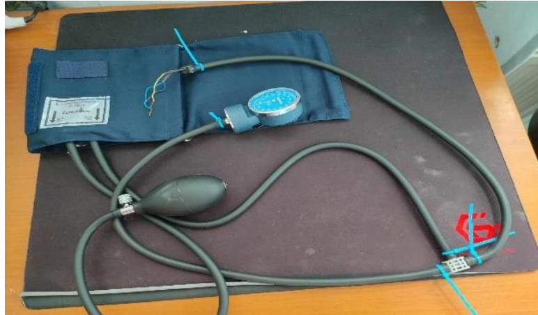
Εικόνα 4.2 Το σετ περιχειρίδας μαζί με το αισθητήριο πίεσης
