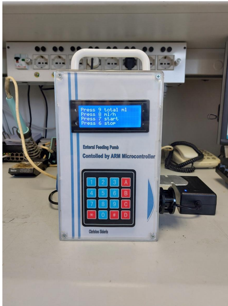
Εικόνα 3.25: Τοποθέτηση πρόσοψης και οθόνης LCD
