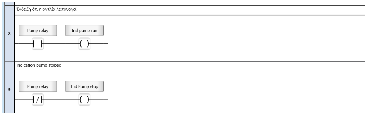
Σχήμα 3.13: Λογική δημιουργίας των ενδείξεων λειτουργίας και διακοπής της αντλίας.
