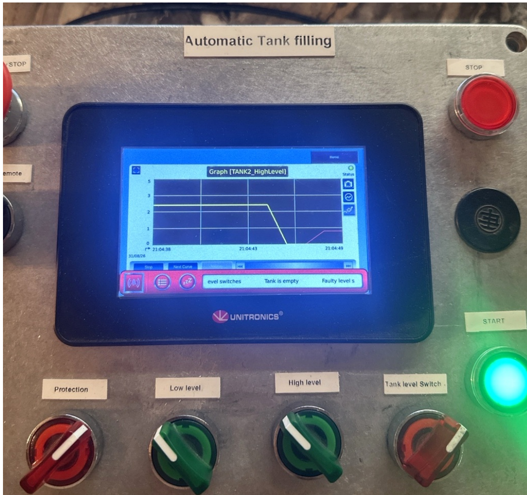
Σχήμα 4.5: Γραφική απεικόνιση της μεταβολής του σήματος υψηλής στάθμης κατά τη διάρκεια των δοκιμών.
