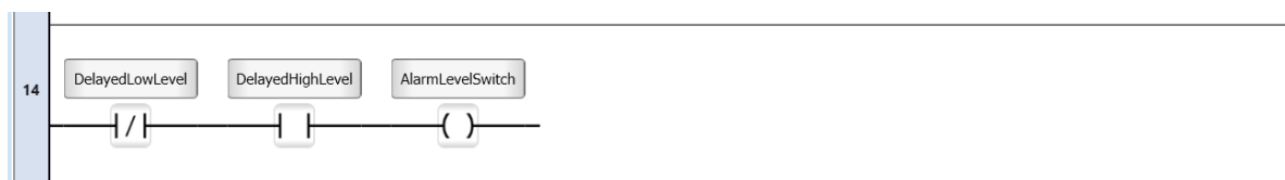
Σχήμα 3.16: Λογική ανίχνευσης μη συμβατής κατάστασης των αισθητήρων στάθμης.
