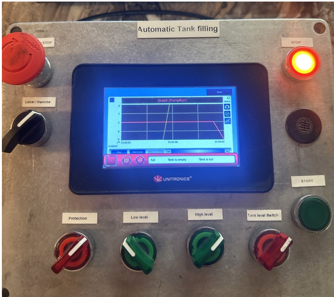
Σχήμα 4.3: Γραφική καταγραφή της μεταβολής της κατάστασης λειτουργίας της αντλίας μέσω της μεταβλητής PumpRun.
