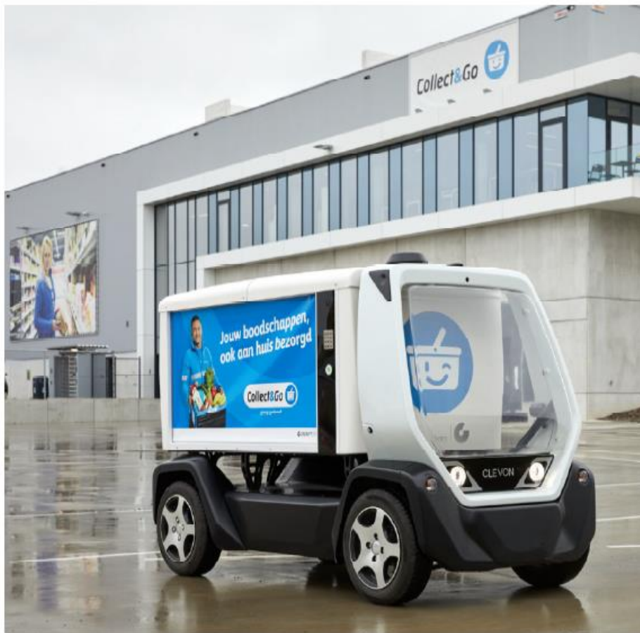
Σχήμα 1.2 Αυτόνομο ρομπότ παράδοσης δρόμου που εξετάζεται στο Βέλγιο [8]
