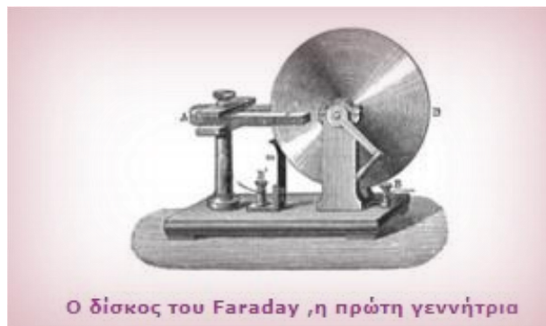
Σχήμα 2. 15: <<Ο δίσκος του Φάραντεϊ, η πρώτη ηλεκτρογεννήτρια στην ιστορία, ένας τύπος ομοιοπολικής γεννήτριας>> (Πηγή : [28])
