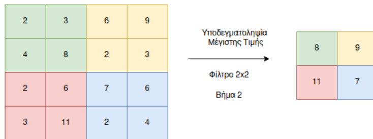
Σχήμα 4.11: Υποδειγματοληψία μέγιστης τιμής με φίλτρο 2x2 και βήμα 2
