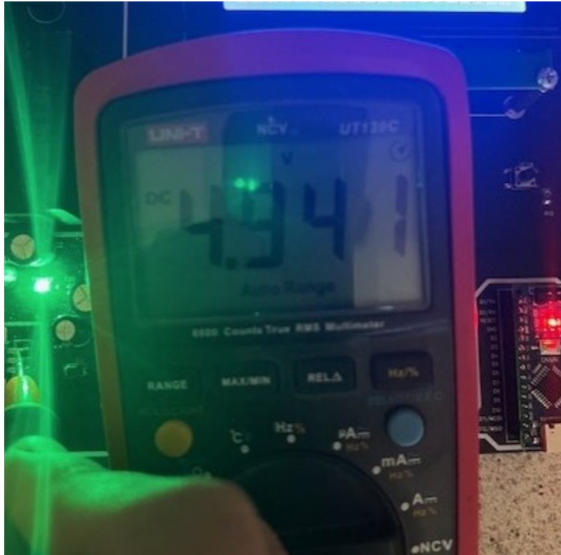
Εικόνα 5.9: Μέτρηση τάσης 5V
