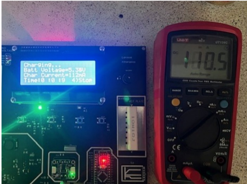
Εικόνα 5.16: Μέτρηση ρεύματος φόρτισης
