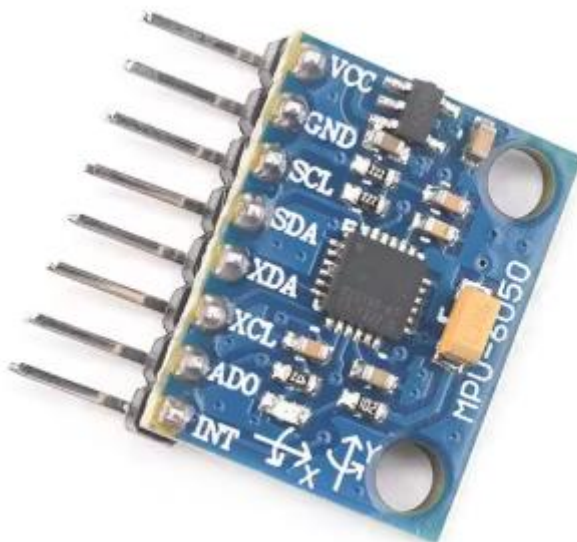
Σχήμα 4.11 Ένα τυπικό Γυροσκόπιο οκτώ (8) ακροδεκτών
