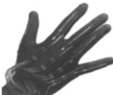
Σχήμα 2.3: Ενσύρματα γάντια με οπτικές ίνες [28]
