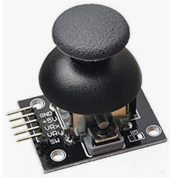
Σχήμα 4.12 Ένα τυπικό Joystick πέντε (5) ακροδεκτών
