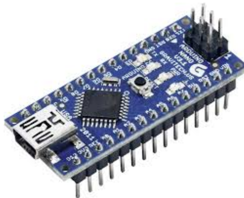
Σχήμα 2.7 – πλακέτα Arduino με εκφρασμένο πάνω του τον ATmega328
