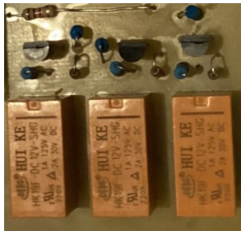
Εικόνα 3.20 : Ρελέ ελέγχου αντιστάσεων
