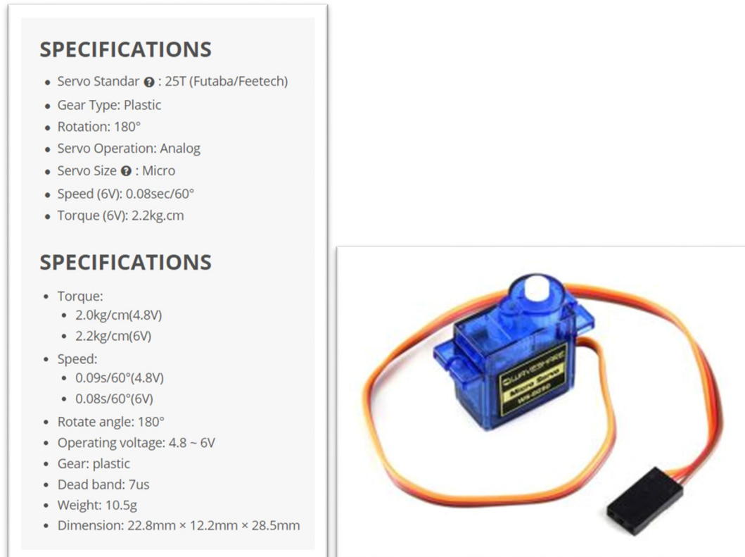
Εικόνα 4.25: Προδιαγραφές microservo SG90
