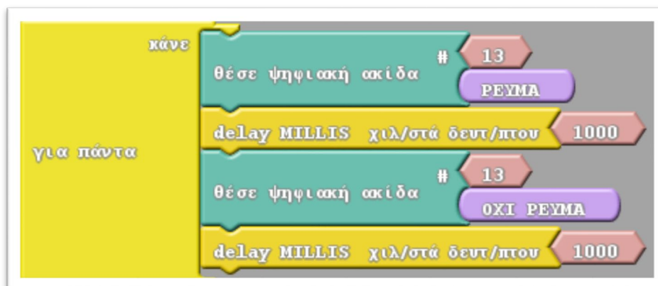
Εικόνα 4.14: Κύκλωμα που ανάβει και σβήνει ένα LED
