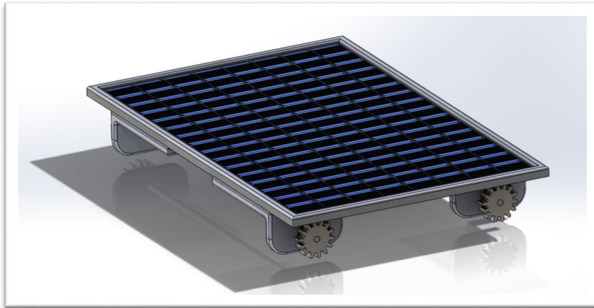
Εικόνα 4.31: Σύστημα κίνησης του φωτοβολταϊκού
