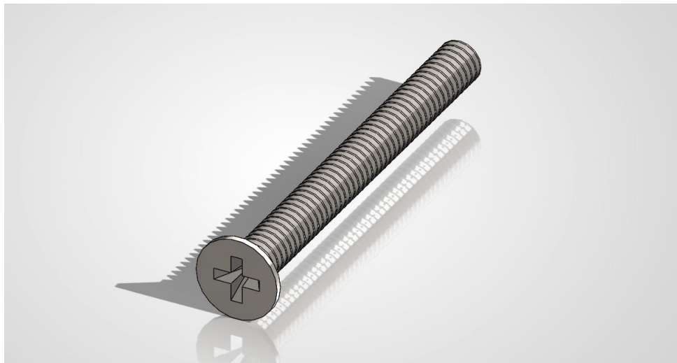
Σχήμα 7.20 Τρισδιάστατη απεικόνιση κοχλία με σταυροειδή εγκοπή.
