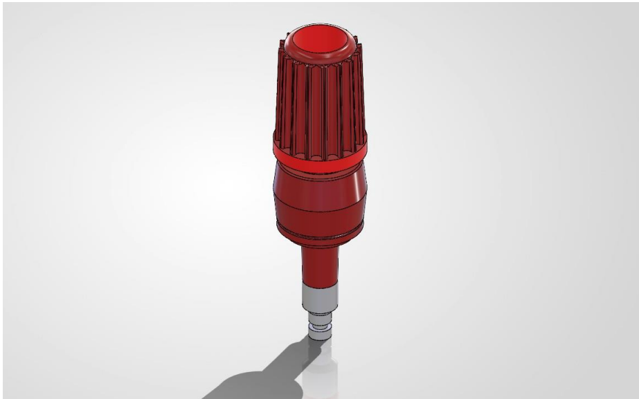
Σχήμα 7.9 Τρισδιάστατη απεικόνιση μπόρνας.
