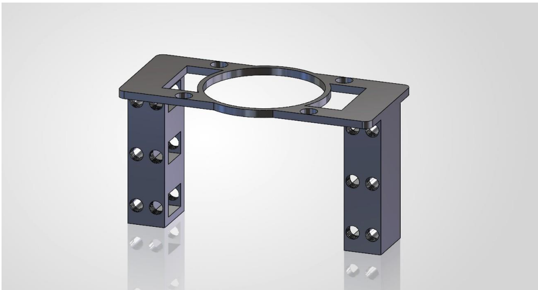
Σχήμα 7.7 Τρισδιάστατη απεικόνιση βάσης στήριξης κινητήρα.
