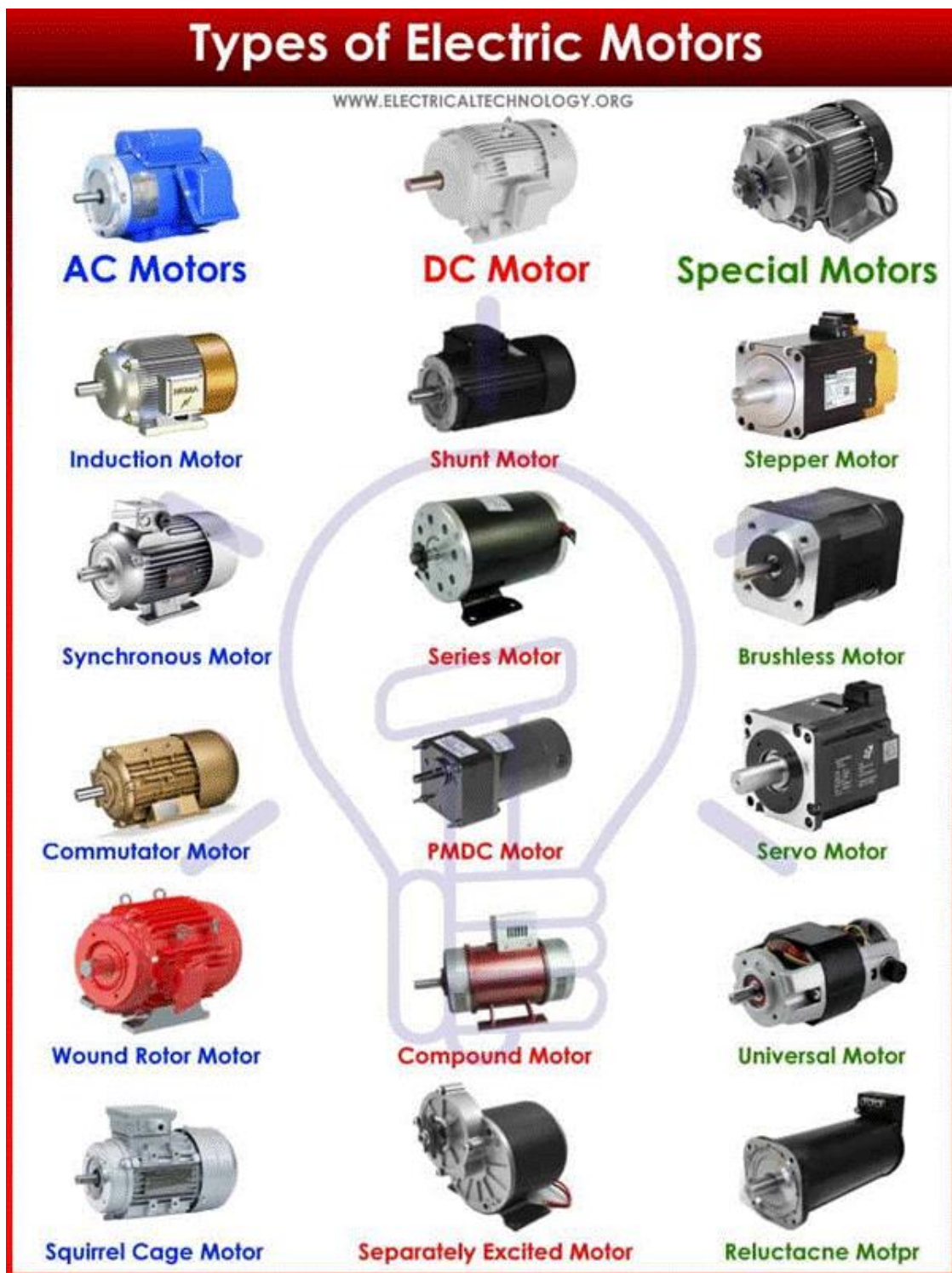
Σχήμα 3.1 Τύποι ηλεκτρικών κινητήρων. Πηγή: https://englishan.com/types-of-motors/
