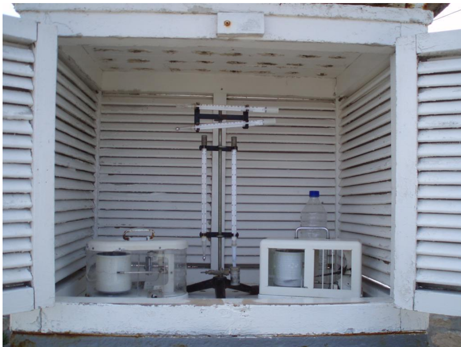
Εικόνα 2.15: Το εσωτερικό ενός κλωβού Stevenson [46]
