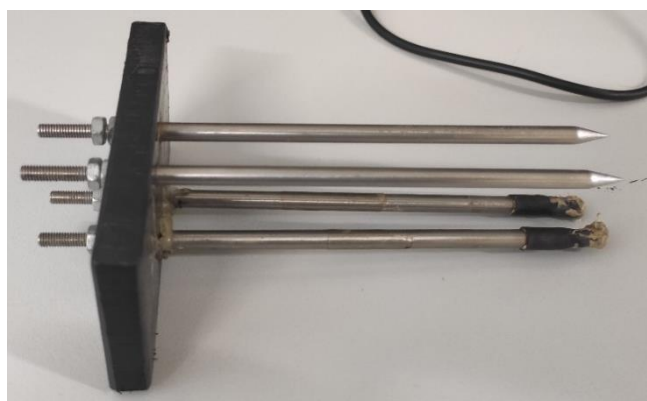
Εικόνα 4.13: Υλοποιημένο τμήμα ηλεκτροδίων αισθητήρα υγρασίας εδάφους
