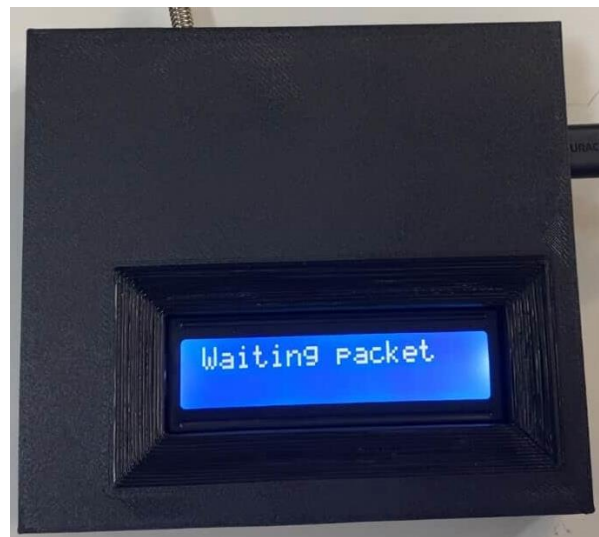
Εικόνα 5.10: Εκτυπωμένο κουτί για την πλακέτα του τμήματος Receiver
