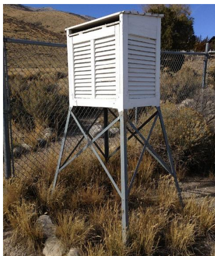
Εικόνα 2.14: Ένας παραδοσιακός μετεωρολογικός κλωβός Stevenson [43]
