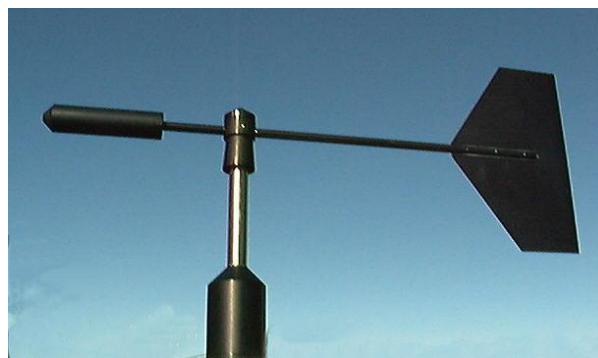
Εικόνα 2.10: Απλός Μετεωρολογικός Ανεμοδείκτης [40]
