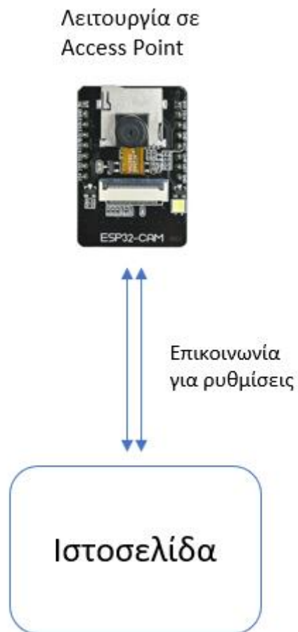
Εικόνα 2.6: Ρύθμιση του esp32 ως access point
