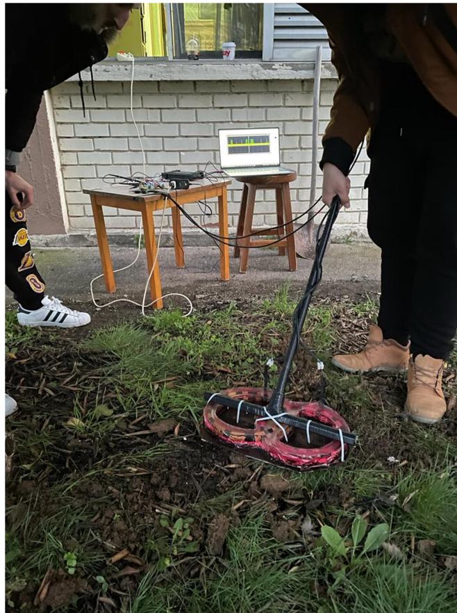
Εικόνα 28: Απεικόνιση σήματος με τον παλμογράφο εν ώρα ανίχνευσης ενός μεταλλικού αντικειμένου
