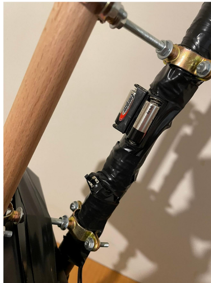
Εικόνα 16: Μπαταριοθήκες και διακόπτης ON/OFF
