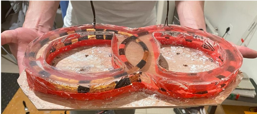
Εικόνα 9: Αφαίρεση της ρητίνης από το καλούπι
