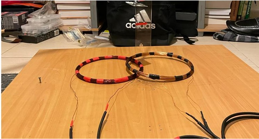
Εικόνα 6: Τα πηνία μετά από την ολοκλήρωση τυλίγματος
