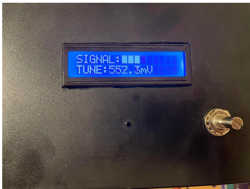
Εικόνα 3: Γραφική απεικόνιση στην οθόνη του σήματος για μέτρια παρουσία του σήματος
