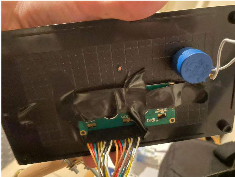
Εικόνα 15: Τοποθέτηση ποτενσιομέτρου και οθόνης
